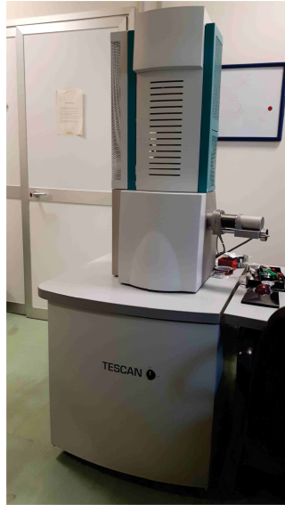
Figura 3.1: Microscopio elettronico a scansione (SEM) disponibile presso i Laboratori Nazionali di Legnaro (Tescan Vega 3xmh).
