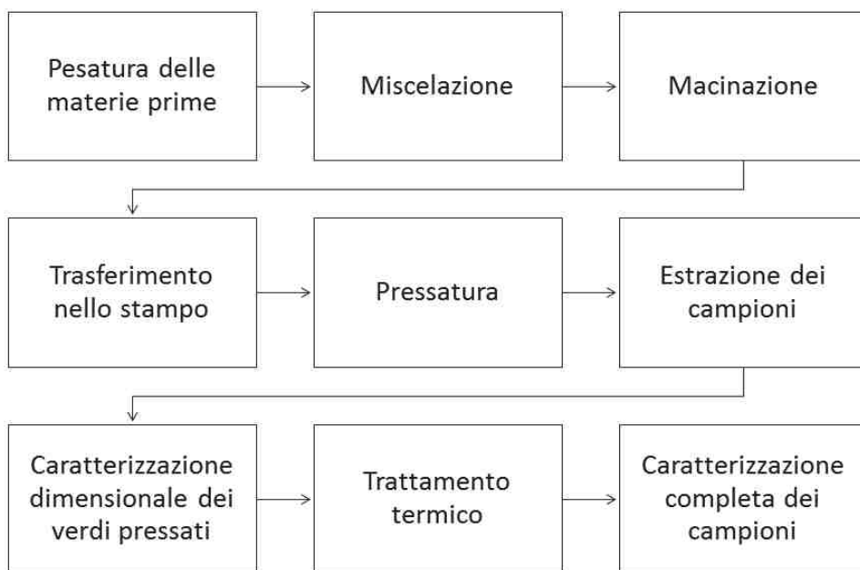
Figura 4.1: Schema del processo produttivo per i campioni in carburo di Titanio.
