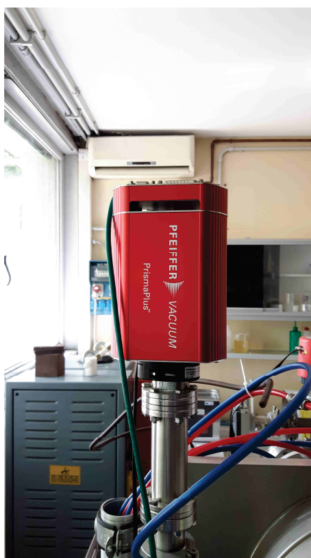
Figura 3.14: Lo spettrometro di massa ai Laboratori Nazionali di Legnaro (Pfeiffer Prisma Plus QMG220 M3).
