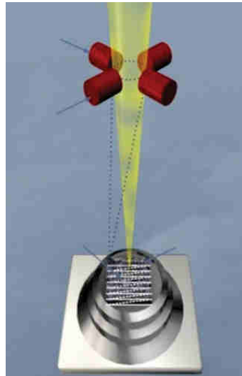
Figura 3.3: Schema rappresentante le bobine di deflessione per un SEM.
