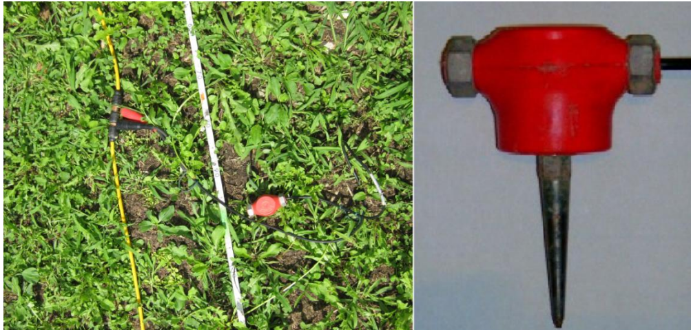
Figura 8. Geofono posizionato nel terreno e collegato tramite pinze al cavo elettrico.
