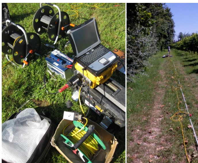
Figura 7. A destra, la strumentazione in acquisizione; a sinistra, il posizionamento di uno stendimento.
