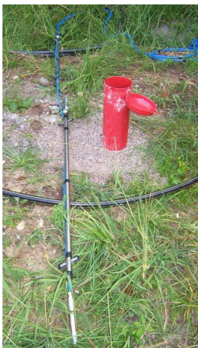
Figura 4.8 – Sonda inclinometrica (II bis) e piezometro.
