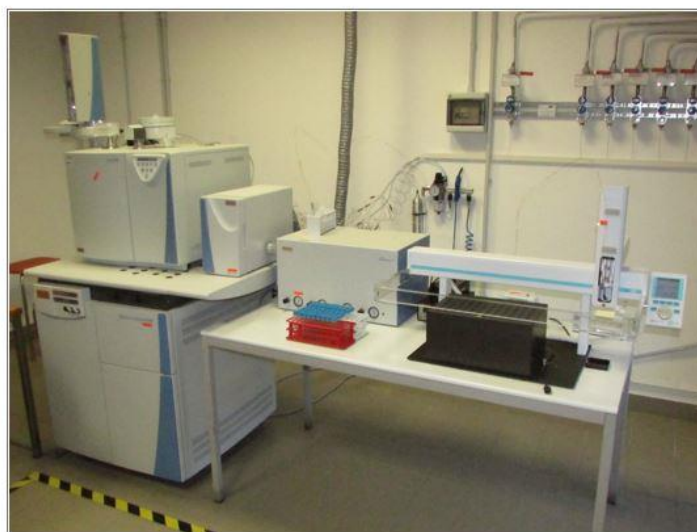
Figura 3.7. Spettrometro di massa Thermo Scientific Delta V Advantage, connesso a Thermo Gassbench II, del Laboratorio di analisi degli isotopi stabili del Dipartimento di Geoscienze, Università di Padova.
