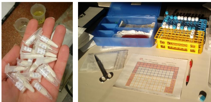
Figura 3.5. A sinistra: capsule in polietilene siglate, contenenti le polveri dei vari campioni. A destra: piano di lavoro per la preparazione dei campioni, rack contenente le provette per l'analisi spettrometrica e relativa cartella cartacea con le posizioni e le quantità di ciascun campione.
