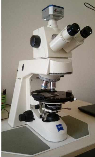
Figura 3.4. Microscopio ottico polarizzatore con fotocamera DeltaPix, utilizzati per l'analisi micropaleontologica.
