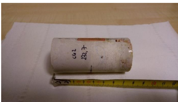
Figura 4.1: provino di Calcari Grigi disomogeneo
