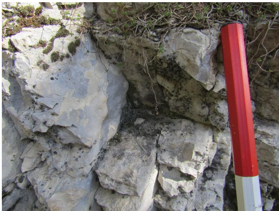
Allegato 11.1: affioramento di Maiolica in Valle del Mis sul quale è stata eseguita la stazione geomeccanica e il prelievo di campioni. GSI stimato in campagna 40+5
