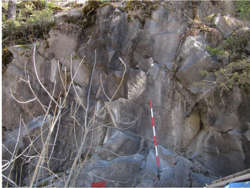
Allegato 8.1: Affioramento della Formazione del Monte Fernazza ad Alleghe sul quale è stata eseguita la stazione geomeccanica e il prelievo di campioni. È costituito da arenarie vulcanoclastiche nere, non si distingue la stratificazione. GSI stimato in campagna 75+-5
