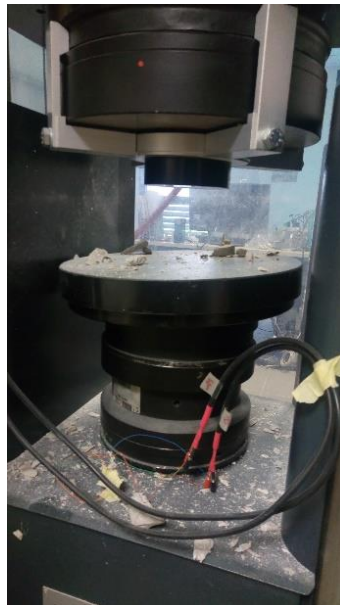
Allegato 11.2: tutti i provini sono esplosi
