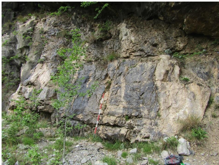
Allegato 6.1: affioramento di Dolomia dello Sciliar a Listolade sul quale è stata effettuata la stazione geomeccanica e la raccolta di campioni. GSI stimato in campagna 70+-5
