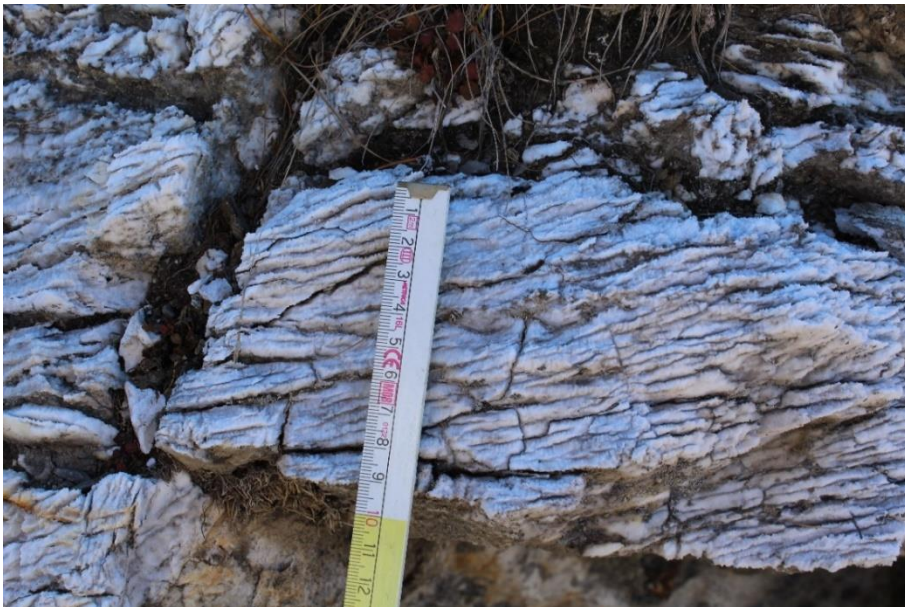
Allegato 3.2: gessi fittamente laminati intercalati a sottili livelli argillosi
