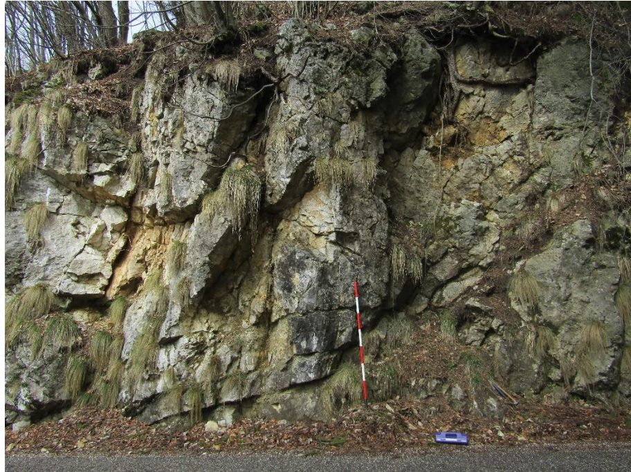
Allegato 10.1: affioramento di Calcari Grigi sul Monte Grappa sul quale è stata eseguita la stazione geomeccanica. GSI stimato in campagna 50+-5
