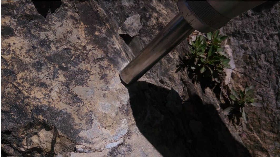
Figura 2.4: confronto tra la superficie naturale e quella levigata con la pietra smeriglio, sulla quale è appoggiata la punta dell'asta del martello
