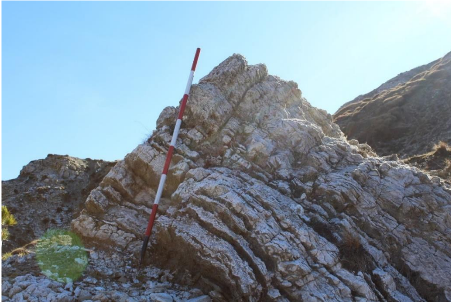
Allegato 3.1: affioramento di Formazione a Bellerophon nei pressi di Passo Valles sul quale è stata effettuata la stazione geomeccanica e il prelievo di campioni. GSI stimato 30+-5
