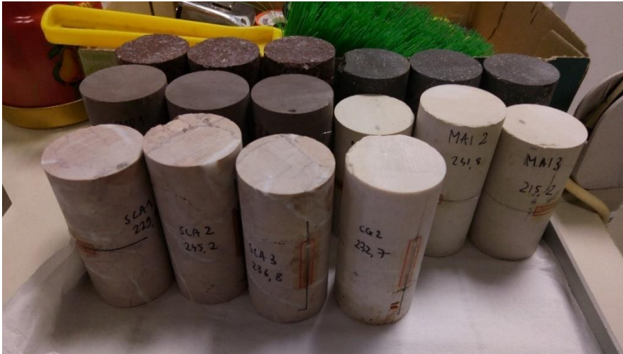
Figura 2.10: alcuni dei provini utilizzati per la prova di compressione semplice. Su ogni provino è scritta la propria sigla identificativa e il peso in grammi.
