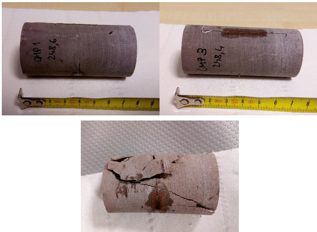
Allegato 5.3: provino CMP1 dopo la prova di compressione uniassiale
