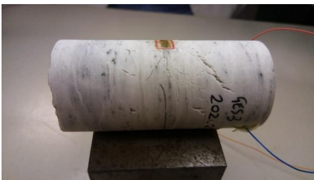
Figura 4.2: provino di Formazione a Bellerophon microfratturato
