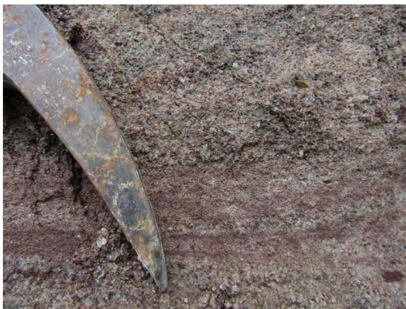
Allegato 2.2: Arenarie grossolane costituite prevalentemente da granuli di quarzo
