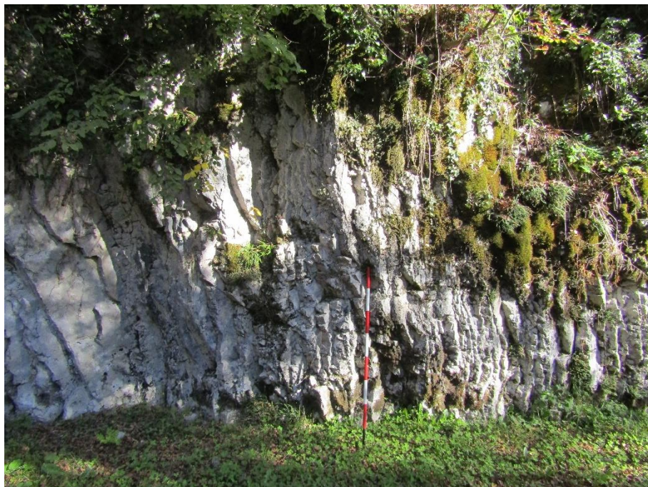
Allegato 11.1: affioramento di Maiolica in Valle del Mis sul quale è stata eseguita la stazione geomeccanica e il prelievo di campioni. GSI stimato in campagna 40+5
