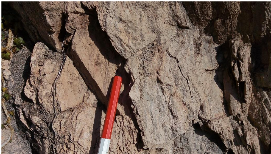
Allegato 12.1: affioramento di Scaglia Rossa in Valle del Mis sul quale è stata eseguita la stazione geomeccanica e il prelievo di campioni. GSI stimato in campagna 35+-5
