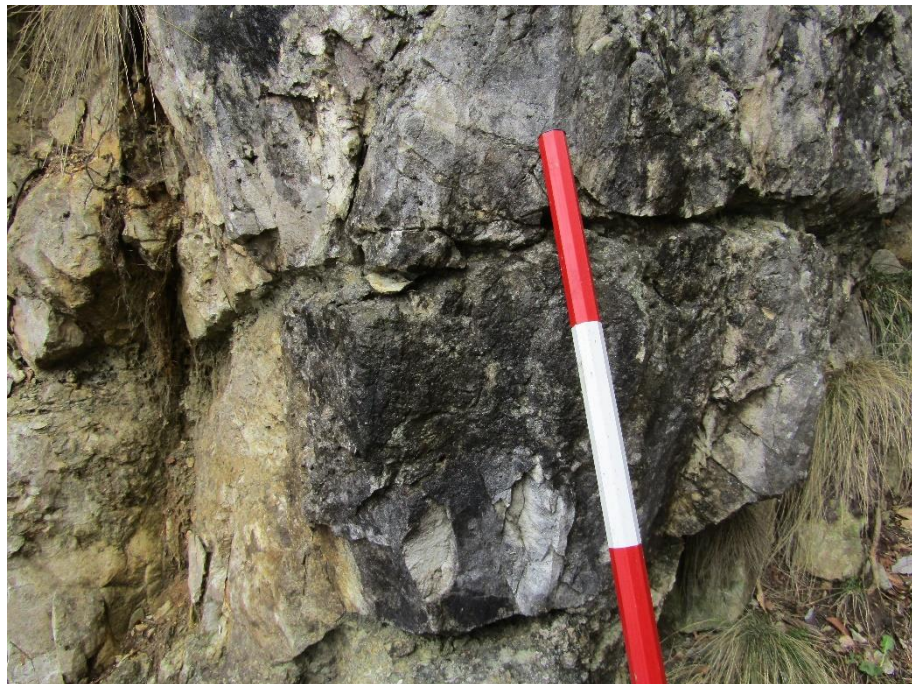
Allegato 10.1: affioramento di Calcari Grigi sul Monte Grappa sul quale è stata eseguita la stazione geomeccanica. GSI stimato in campagna 50+-5
