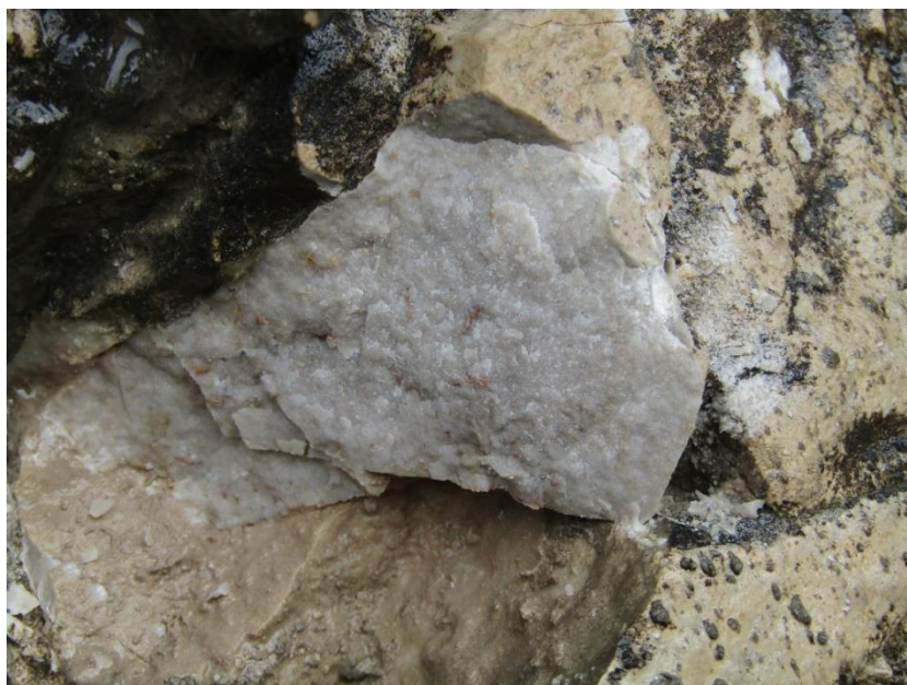
Allegato 6.2: carbonato cristallino, tessitura deposizionale non riconoscibile
