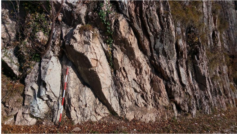
Allegato 12.1: affioramento di Scaglia Rossa in Valle del Mis sul quale è stata eseguita la stazione geomeccanica e il prelievo di campioni. GSI stimato in campagna 35+-5
