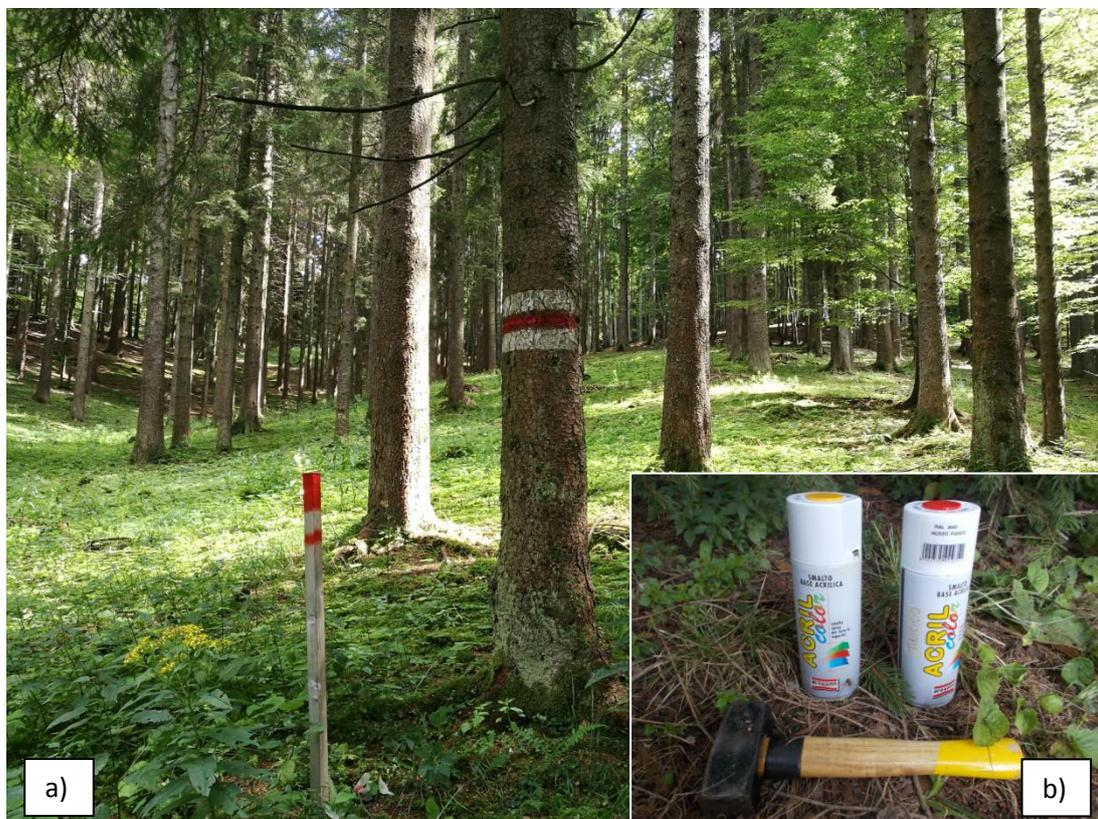
**Figura 3.11:** a) Paletti verniciati all'estremità superiore, delimitatori delle aree di battuta in squadra; b) smalto acrilico spray e mazzetta.
