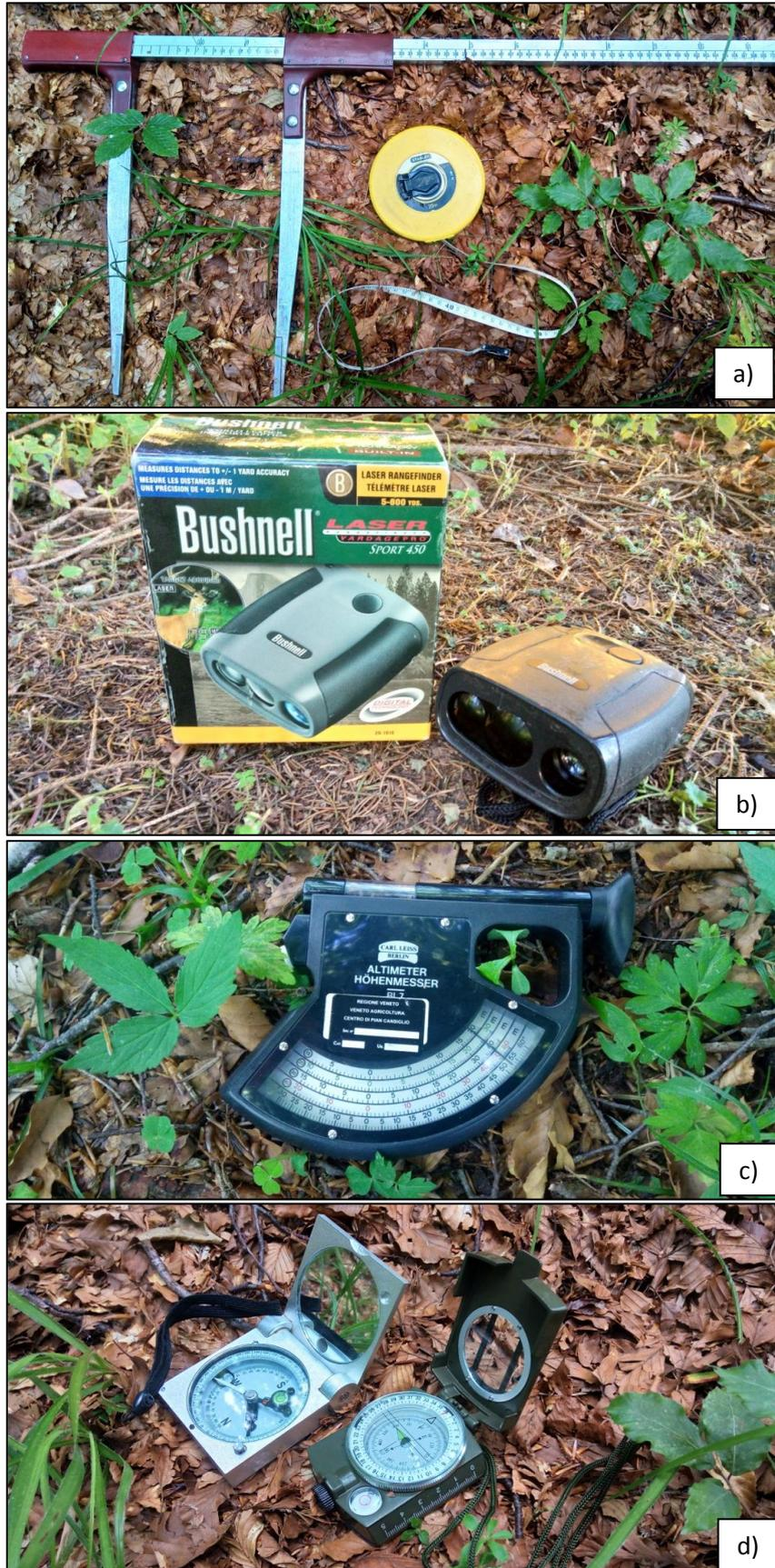
**Figura 3.9:** a) Cavalletto forestale e cordella metrica; b) Telemetro laser; c) Ipsometro; d) Clinometro e bussola. (Foto Giovanni Benetton).
