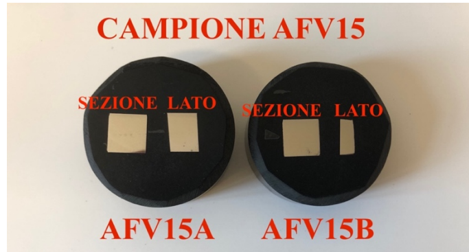
Figura 20 Esempio di campione metallico inglobato nella resina
