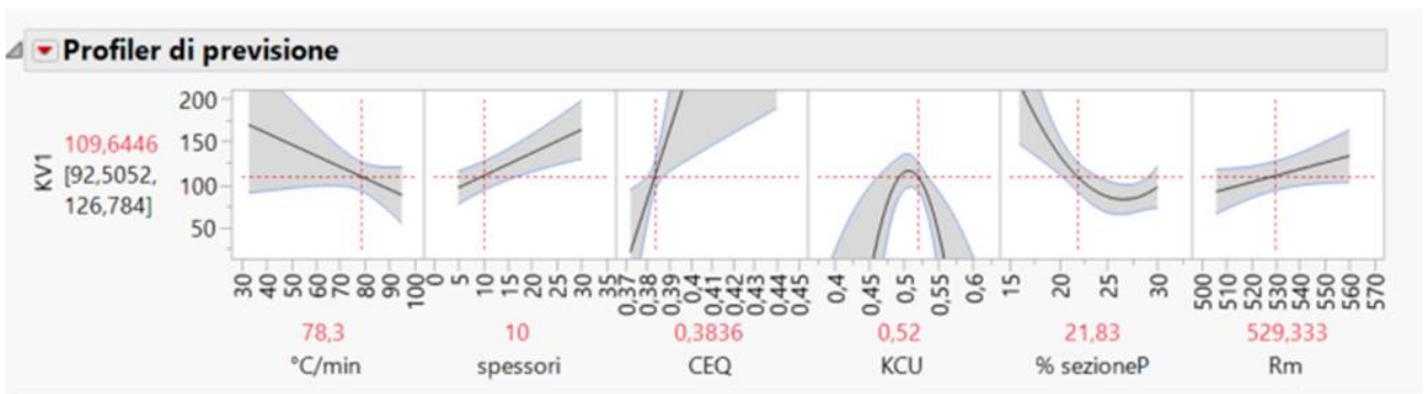
Figura 34 profiler di previsione dello spessore 10 millimetri
