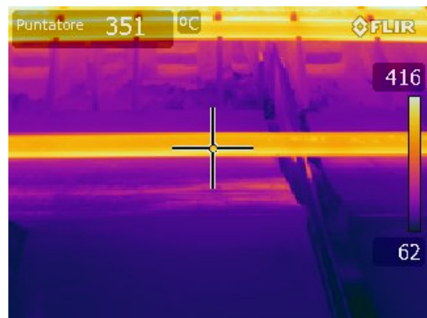
Figura 40 temperatura laminato nella via rulli
