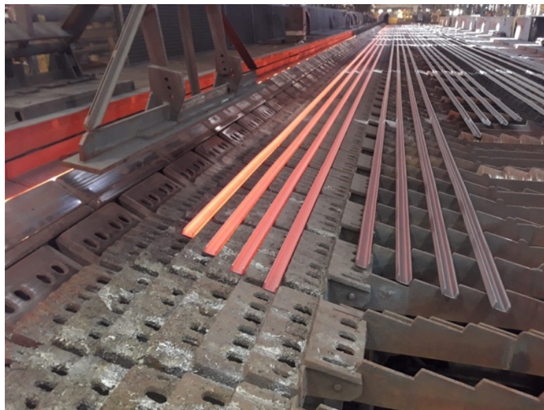
Figura 43 profili PIA100x20 in transito nella placca di raffreddamento
