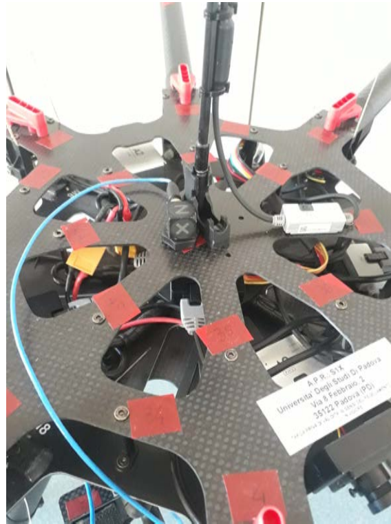
Figura 81: Posizionamento dell'accelerometro nel punto 1, corrispondente al sistema fisso di coordinate per la misurazione.
