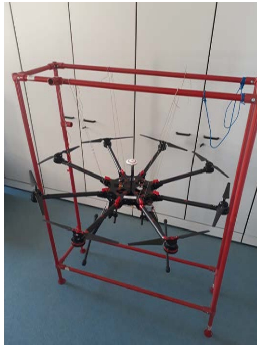
Figura 76: Metodo di fissaggio del drone sul telaio.
