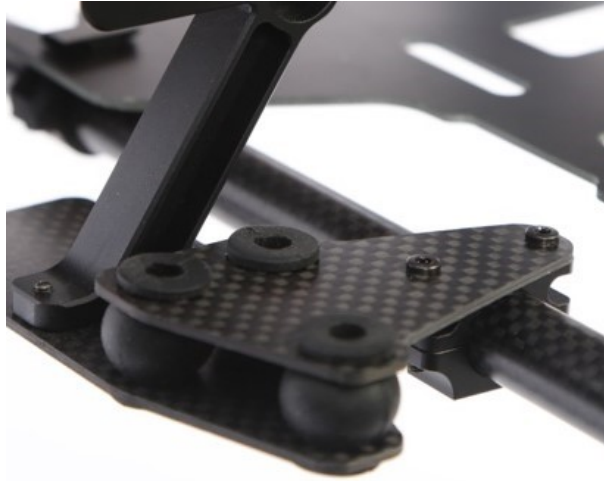
Figura 29: Dettaglio dei componenti in materiale elastomerico situati tra telaio e staffa di montaggio.
