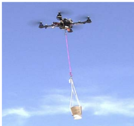
Figura 5: Esempio di UAV equipaggiato con cavi.
