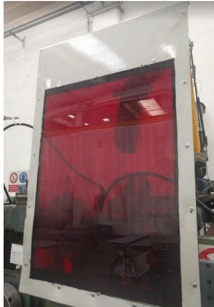
Fig. 6.9: protezione nell'area di saldatura
