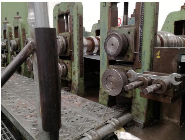
Fig. 5.8: stato del macchinario dopo la pulizia: area rulli a monte della macchina
