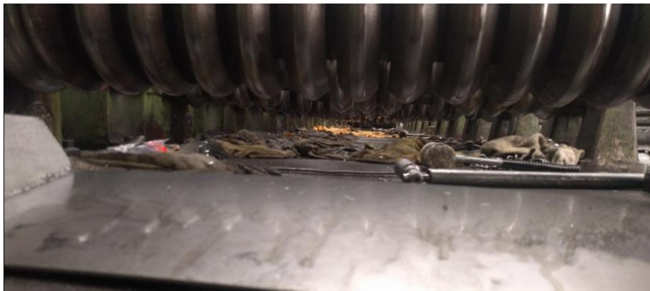
Fig. 5.5: stato del macchinario prima della pulizia, area rulli
