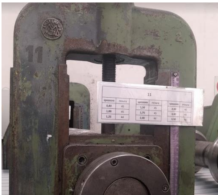
Fig. 6.6: standard di regolazione posto sulla testa numero 11
