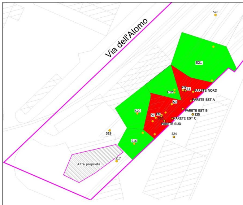
Fig. 5.4 - Delimitazione della sorgente suolo superficiale con poligoni di Thiessen; scala 1:500
