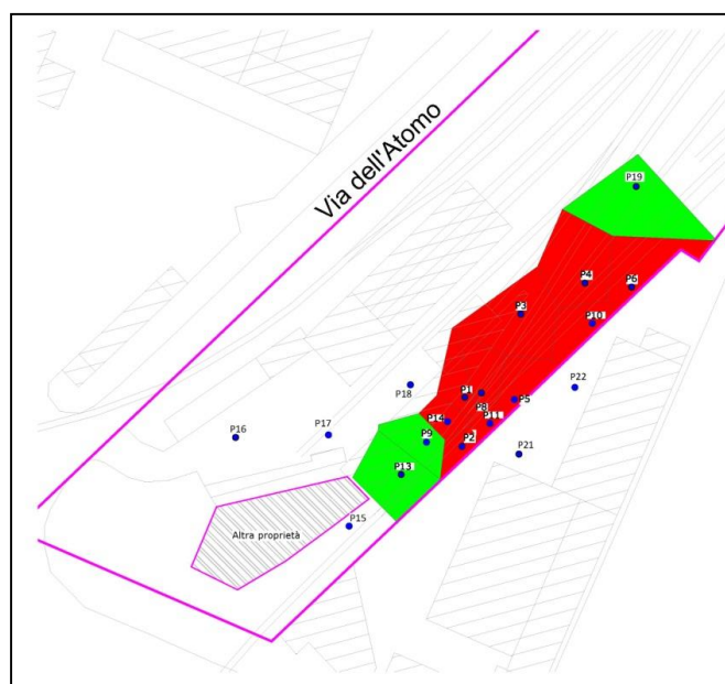
Fig. 5.8 - Delimitazione della sorgente falda con poligoni di Thiessen; scala 1:500
