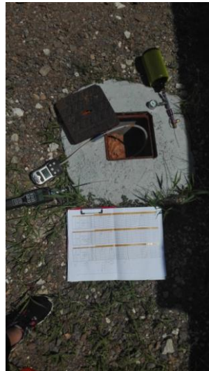
Fig 4.10- Operazione di spurgo pre campionamento con ausilio di Pid e Gas Analyzer
