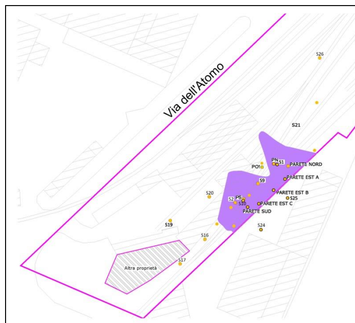
Fig. 5.5 - Area stimata della sorgente di contaminazione in suolo superficiale; scala 1:500
