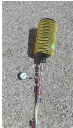
Fig. 4.11 - Canister in vetro usato per il campionamento dei soil gas, collegato a vacuometro.
