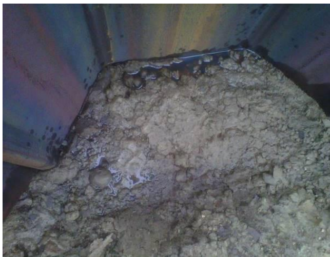
Fig. 4.1 – Particolare del gasolio rilevato nell'area
