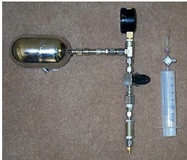
Fig. 3.2 - Canister in acciaio inox collegato a flussimetro
