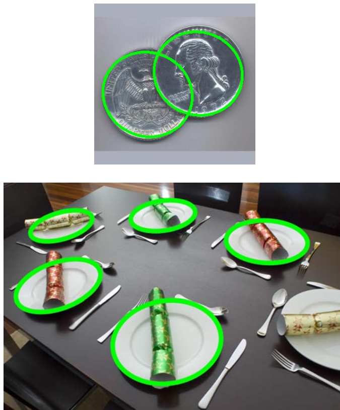
Figura 1.16: Esempi rilevamento ellissi con algoritmo Fornaciari-Prati
