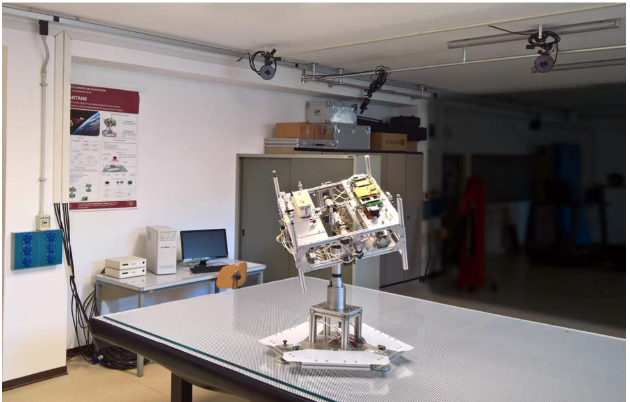
Figura 2.2: Il simulatore di un micro satellite "SPARTANS" nei laboratori dell'Università di Padova
