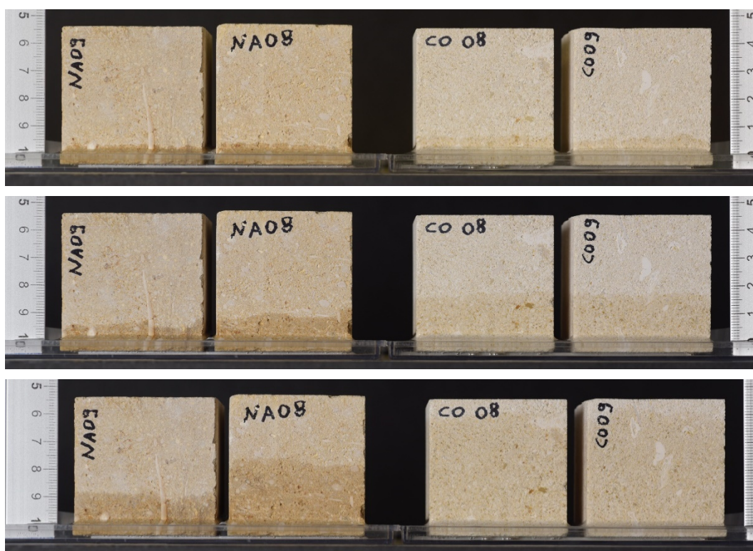
Fig. 5.7: Immagine al tempo 0 (in alto), dopo 5 minuti (al centro) e dopo 30 minuti (in basso) per i campioni di Nanto (NA) e Costozza (CO).
