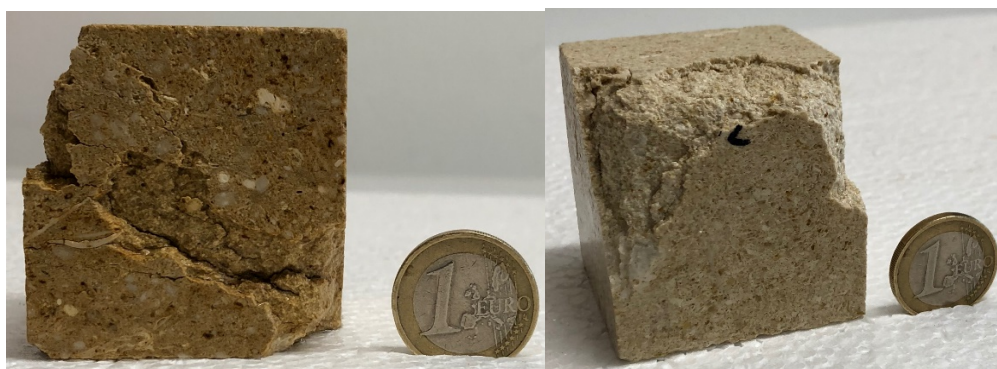
Fig. 5.13: Distacco di materiale in Nanto (a sinistra) e Costozza (a destra) in corrispondenza dei vertici durante la prova di resistenza la gelo.
