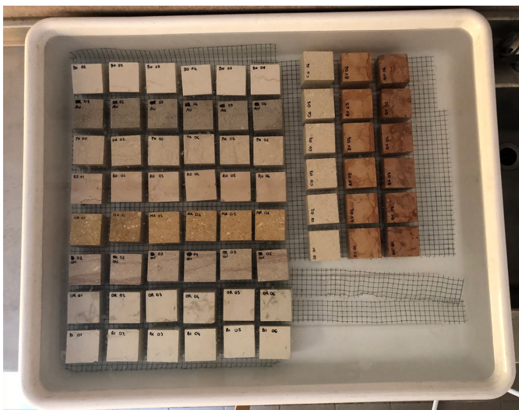
Fig. 4.1: L'insieme dei campioni sottoposti alla prova di imbibizione in acqua durante la fase di immersione.
