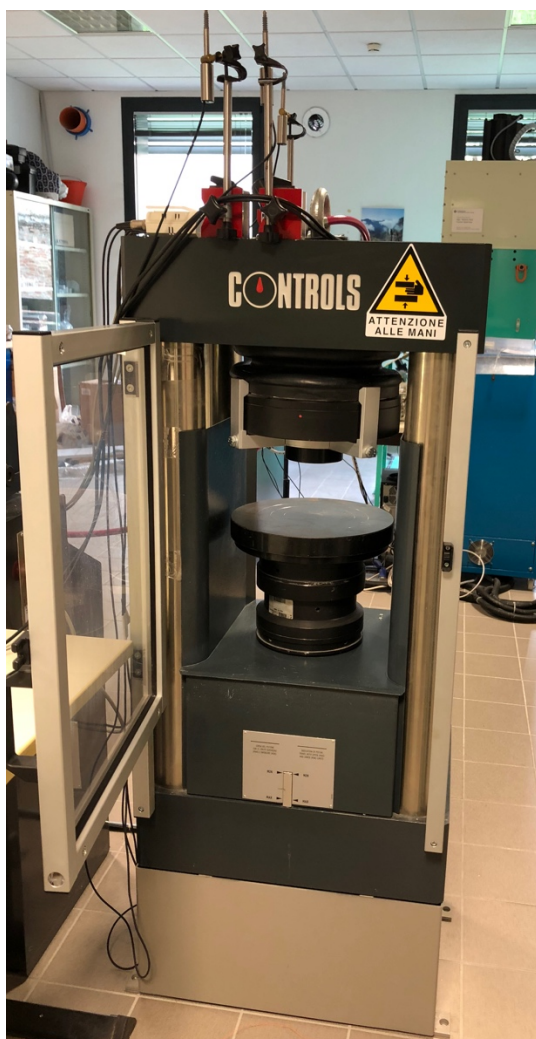
Fig. 4.2: Strumentazione utilizzata per le prove di resistenza al carico.
