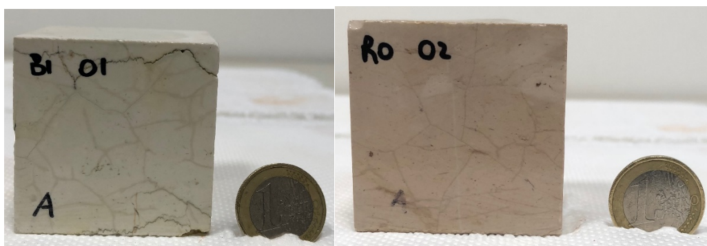
Fig. 5.14: Fratturazione su Bianco e Rosa Asiago dopo 50 cicli di gelivazione, evidenziata in queste immagini dalle linee leggermente più scure sulla faccia del provino.
