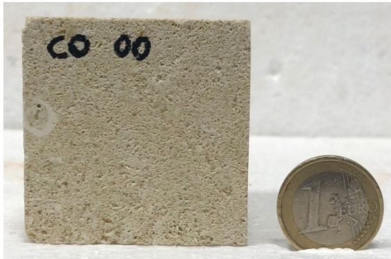
Fig. 2.12: Campione cubico di Pietra di Vicenza “Costozza” con lato di 50 mm.
