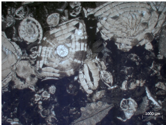
Fig. 2.5: Campione di Chiampo Paglierino in sezione sottile osservato al microscopio ottico, caratterizzato da nummuliti ed altri microfossili.
