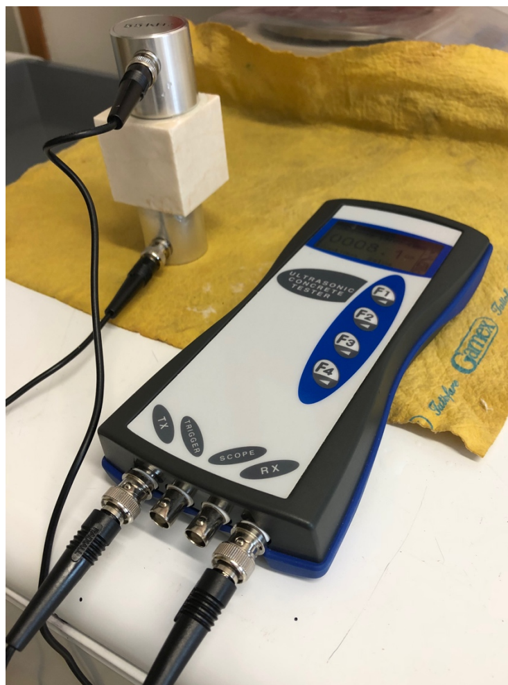
Fig. 4.3: Strumento portatile ad ultrasuoni della MATEST, utilizzato per registrare le velocità ultrasoniche nei diversi provini.
