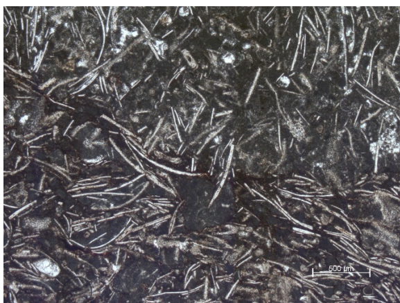
Fig. 2.17: Campione di Bruno Verona in sezione sottile osservato al microscopio ottico, caratterizzato da abbondanti resti di bivalvi a guscio sottile. Frequenti sono anche i livelli ricchi in minerali del gruppo delle argille.
