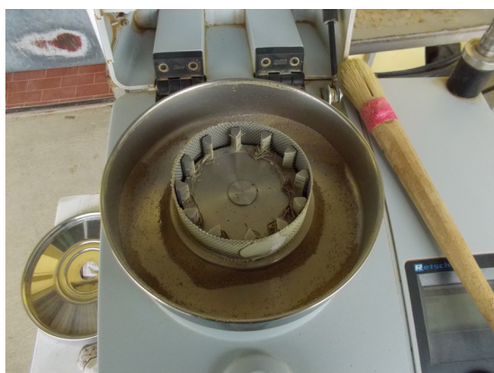
Figura 40: Particolare dell'interno del mulino.
