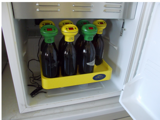
Figura 28: Inserimento dei campioni in stufa.
