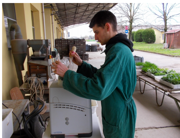
Figura 39: Operazione di macinazione dei campioni secchi di vegetazione.
