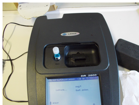
Figura 34: Lettura della cuvetta allo spettrofotometro per la determinazione dei tensioattivi.
