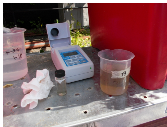
Figura 26: Analisi della torbidità.
