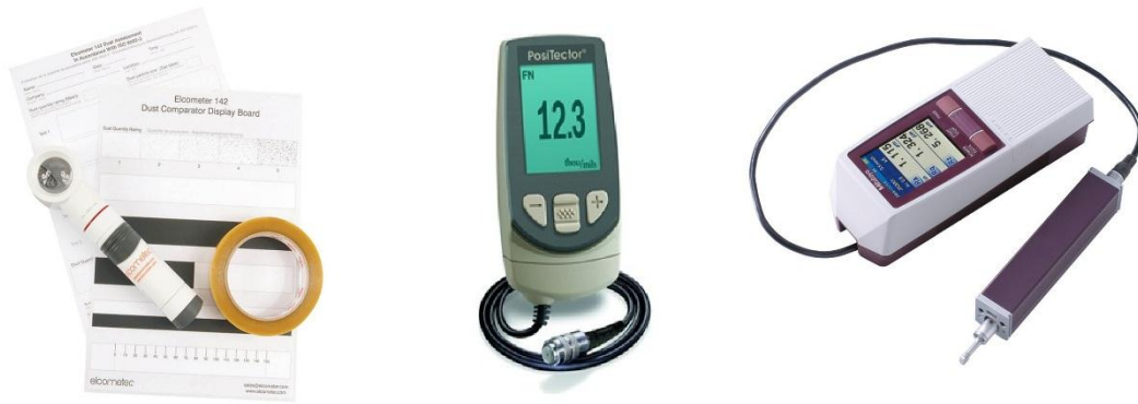
Immagine 56: da sinistra verso destra: Elcometer 142, Defelsko Positector 6000 e Mitutoyo SurfTest SJ 210
