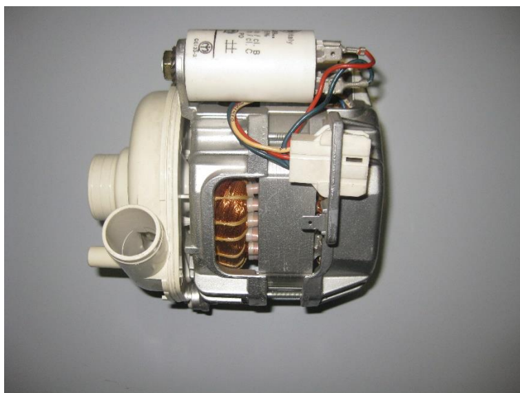
Fig. 1.2-3 Motore asincrono anni '90 con idraulica semplice
