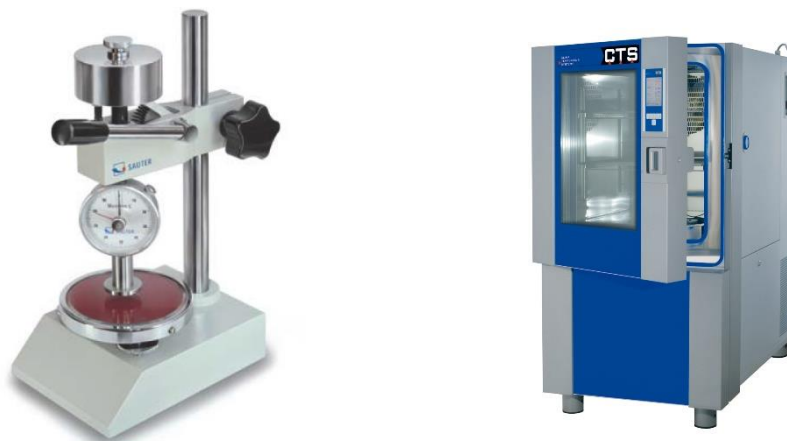
Fig. 5.1-1 Strumentazione di prova durezza Shore
