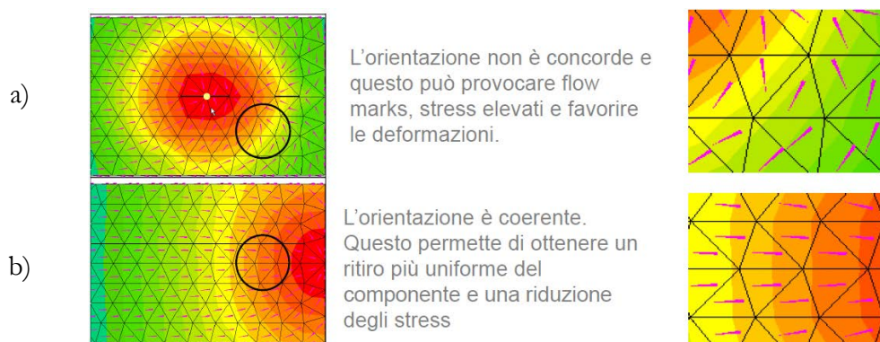
Fig. 2.2-6 Differenze tra flussi in cavità
