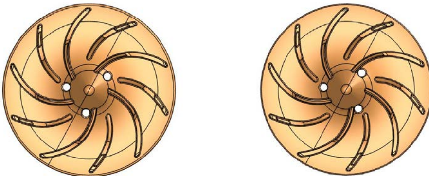
Fig. 6.1-9 Differente disposizione dei fori tra girante attuale e futura
