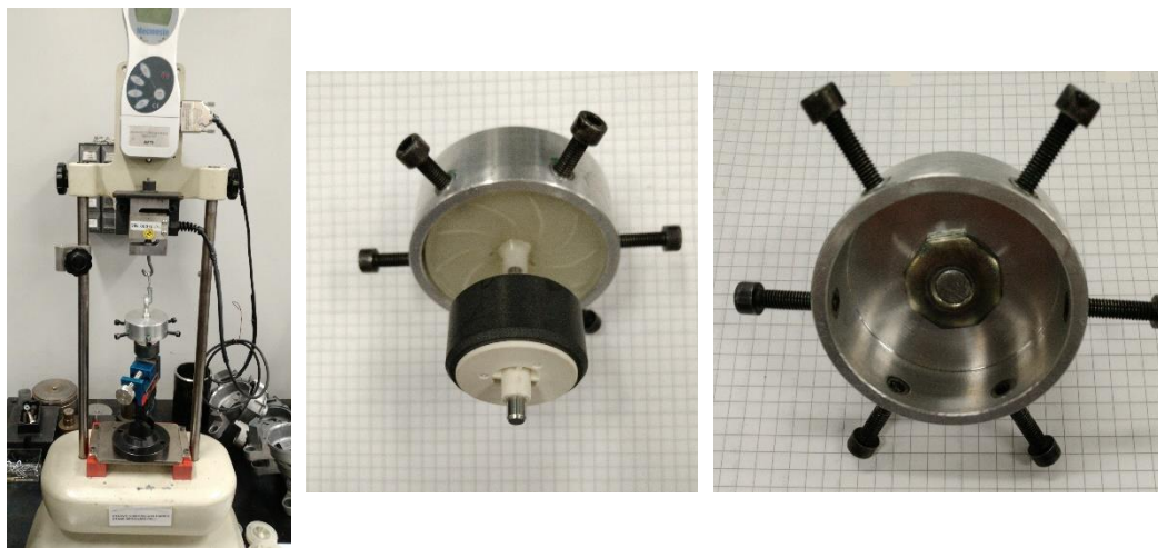
Fig. 5.4-2 Attrezzatura per prova di resistenza saldatura
