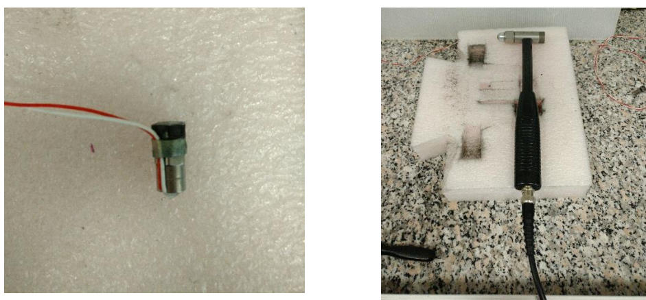
Fig. 5.2-1 Strumentazione di prova analisi in frequenza
