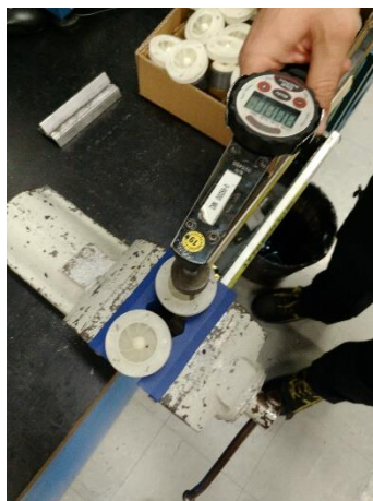
Fig. 5.5-1 Esecuzione prova di svitamento
