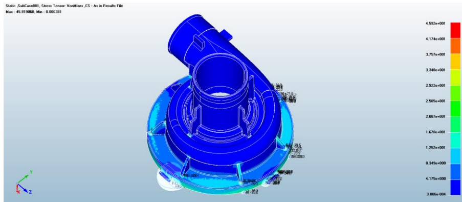
Fig. 6.2-22 Evidenza delle zone con P > 20 \text{ MPa} nella configurazione a P_{med}
