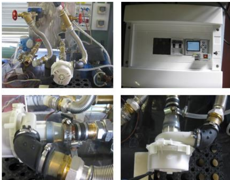
Fig. 3.3-1 Strumentazione di prova, test espulsione aria in voluta
