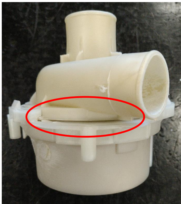
Fig. 7.3-11 Apertura nella sezione di tenuta dovuta alla deformazione
