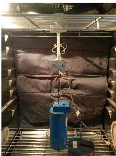
Fig. 5.7-3 Fissaggio del provino in macchina con carico applicato
