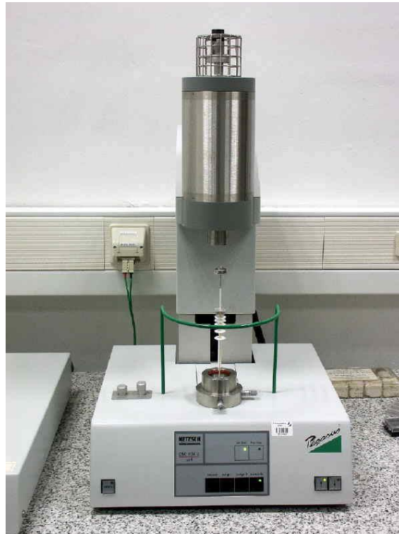
Fig. 3-5: NETZSCH DSC 404 C® machine.
