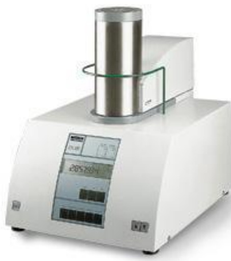
Fig. 3-2: NETZSCH STA 449 C® DTA machine.
