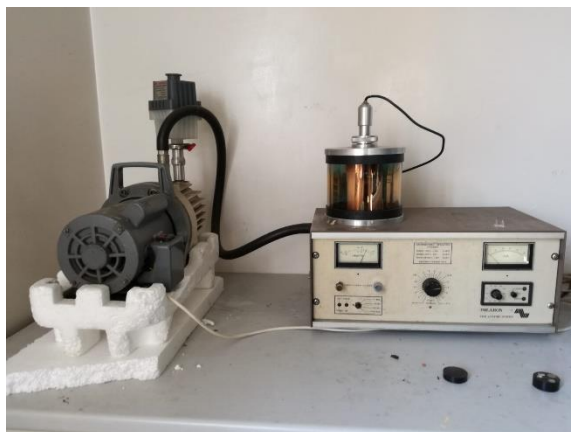
Figura 4.32 Foto della macchina utilizzata per la doratura dei campioni.
