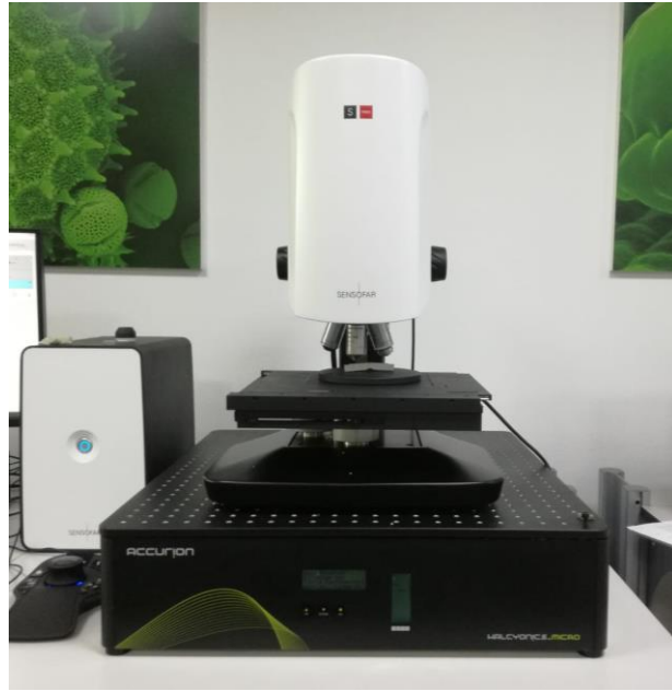
Figura 4.2 Foto del profilometro ottico 3D Sensofar™ Plu Neox scattata nel laboratorio TE.SI di Rovigo.
