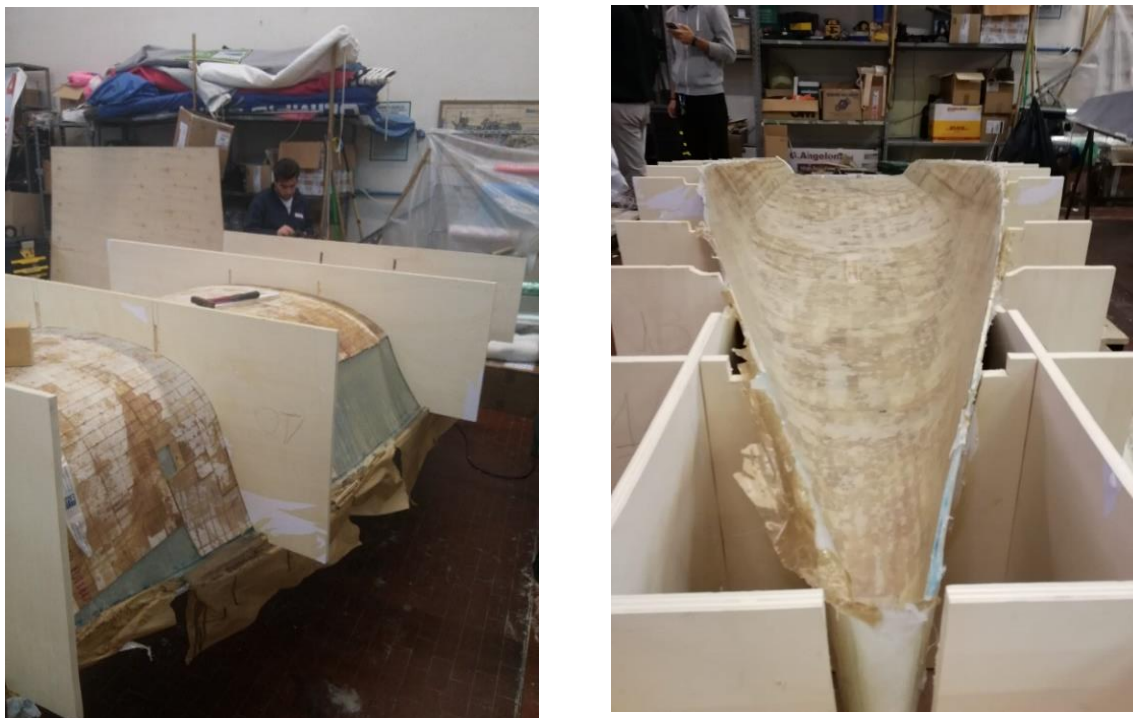
Figura 4.10 Incollaggio delle seste e dei longheroni allo stampo laminato su Ate.
