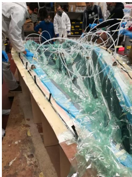
Figura 4.12 Seconda infusione della carena.
