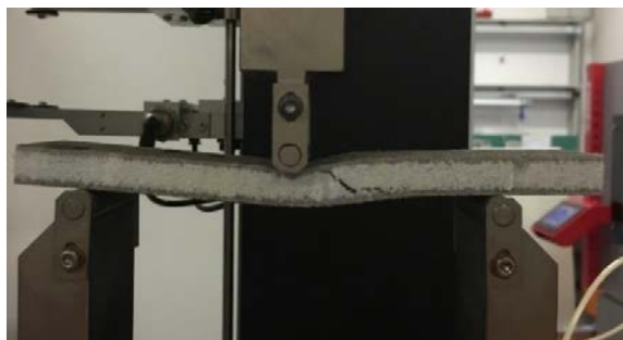
Figura 2.28 Rottura a taglio per sandwich con anima in PET e pelli in epossidica rinforzata con lino.
