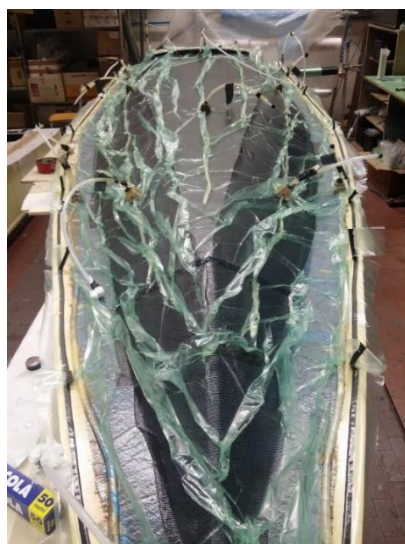
Figura 4.19 Chiusura del sacco della coperta.
