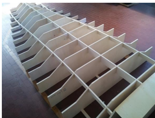
Figura 4.15 Realizzazione dello stampo della coperta con seste e longheroni.
