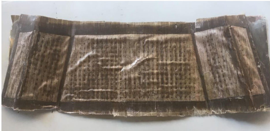
Figura 4.1 (a) Preparazione del primo test di infusione; (b) primo test di infusione fallito.
