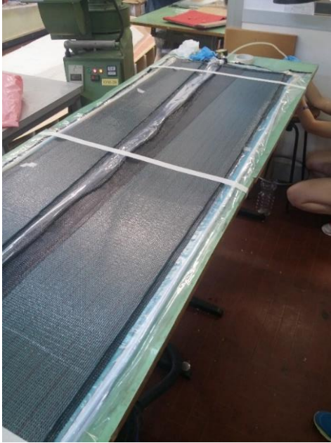
Figura 4.22 (a) infusione dei longheroni; (b) risultato dell'infusione prima di sfridare.
