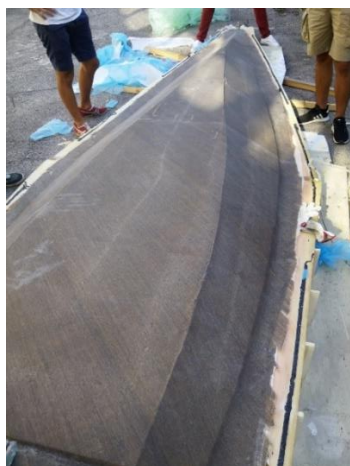
Figura 4.21 Demoulding della coperta.
