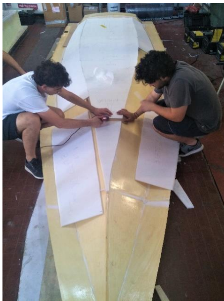
Figura 4.17 Taglio e sagomatura del PET espanso della coperta.
