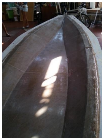
Figura 4.21 Demoulding della coperta.
