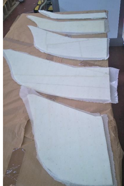
Figura 4.22 (a) infusione dei longheroni; (b) risultato dell'infusione prima di sfridare.
