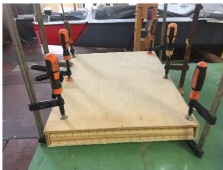
Figura 4.3 Realizzazione dell'inserto della scassa.
