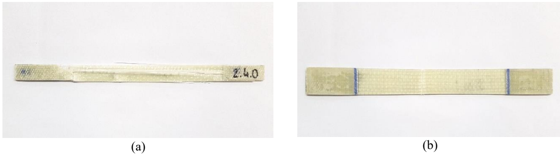
Figura 2.13 Esempio di rottura a trazione dei provini realizzati in fibra di vetro e resina acrilica. (a) Provino con fibre disposte a 0^\circ ; (b) provino con fibre disposte a 90^\circ .
