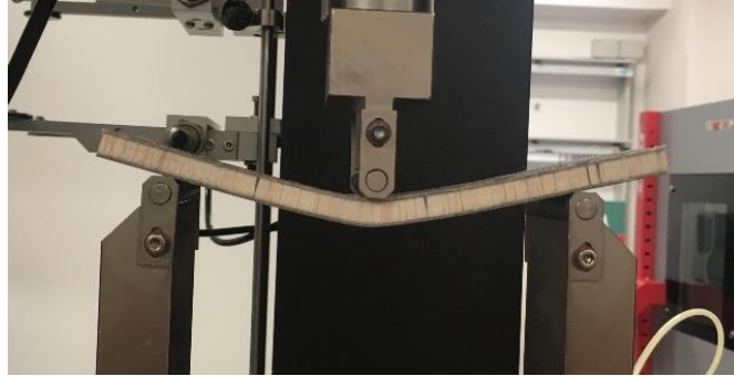
Figura 2.30 Sandwich con anima in balsa e pelli esterne in PMMA rinforzata con fibre di lino, giunto a rottura.
