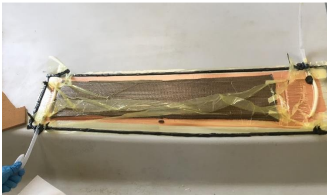
Figura 4.2 (a) secondo test di infusione; (b) secondo test di infusione riuscito.
