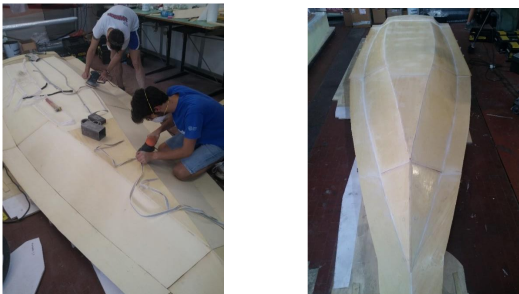
Figura 4.16 Incollaggio e stuccatura dei pannelli superficiali dello stampo.
