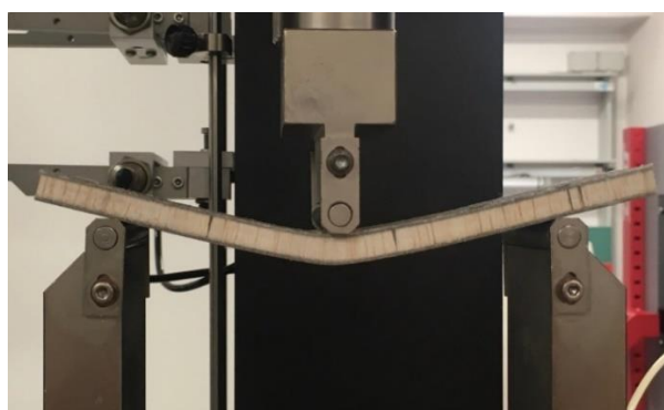
Figura 2.32 Sandwich con anima in balsa e pelli esterne in epossidica rinforzata con fibre di lino, giunto a rottura.
