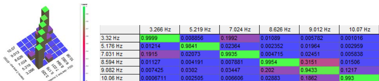
Figura 3.46 – Esempio di comparazione tramite indici di MAC
