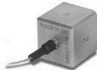
Figura 3.28 - accelerometro capacitivo, sezione trasversale e modello in commercio. [Ramos, 2007, tesi di dottorato]
