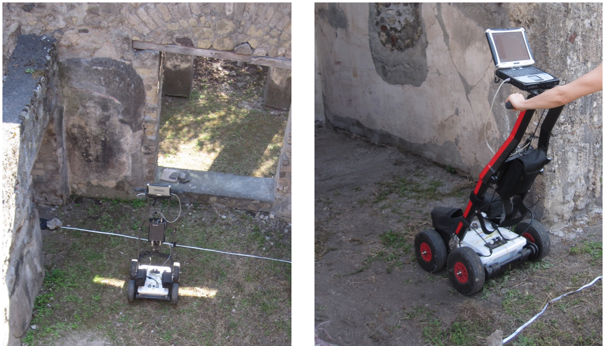
Figura 3.19-3.20 - Esecuzione di prova Georadar a Villa Diomede
