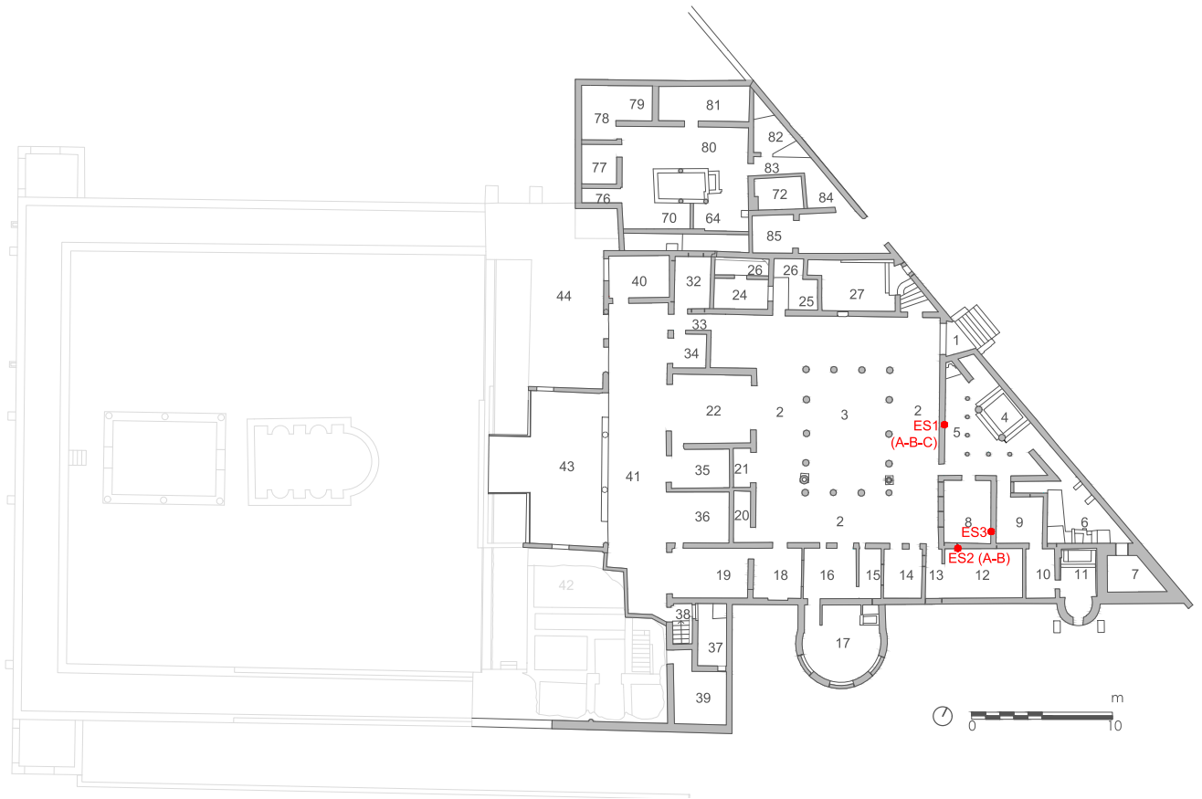
Figura 3.17 – localizzazione prove endoscopiche, piano terra
