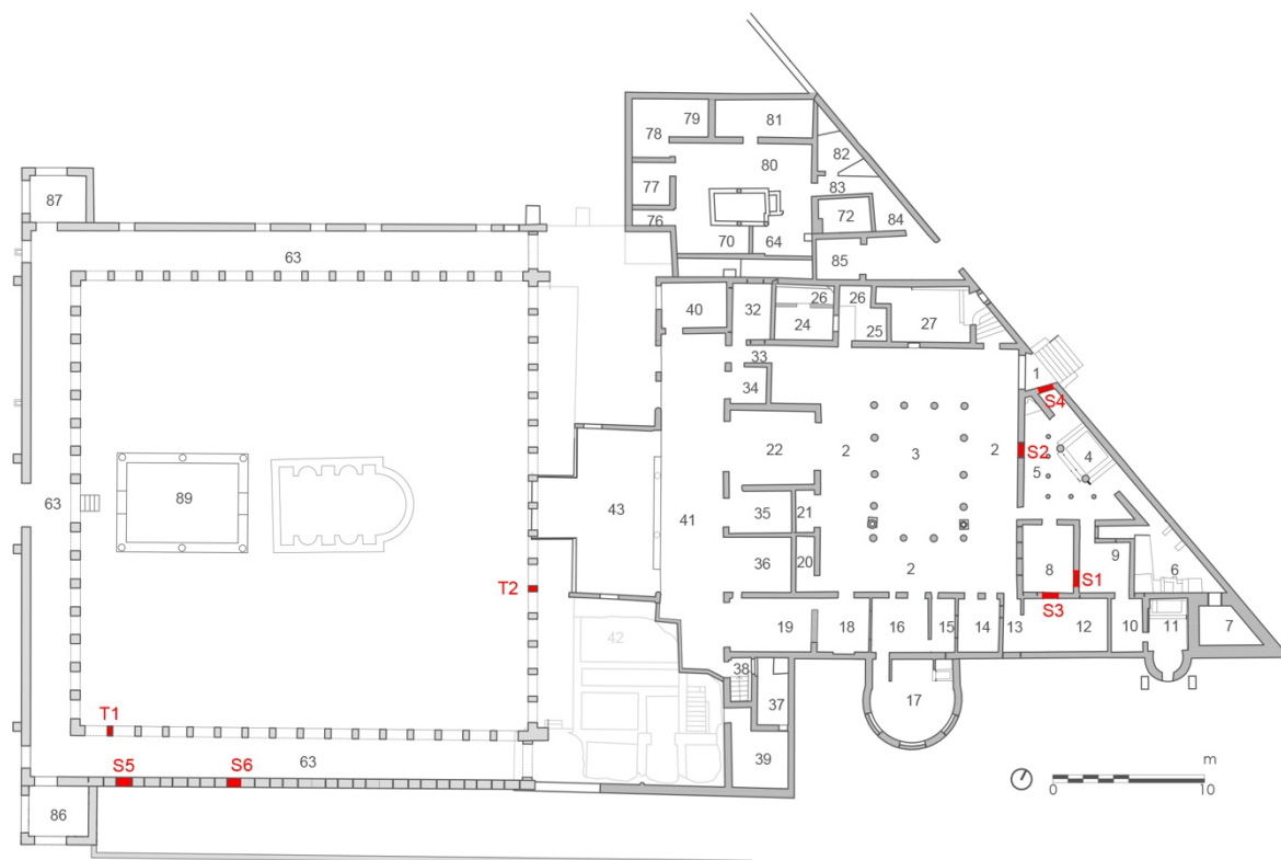
Figura 3.4 - localizzazione delle prove soniche
