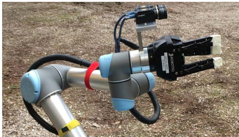
FIGURA 4.9: Sistema di visione stereo del RUR53 con due Grasshopper 3.
