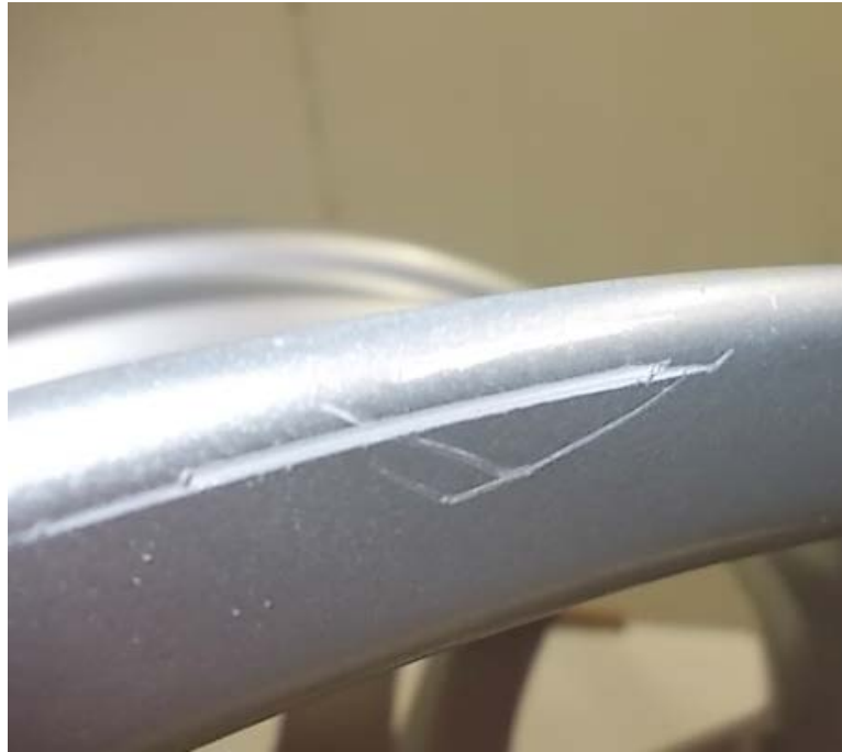
Figura 9.1: Esempio di strisciate rilevate nella postazione di controllo
