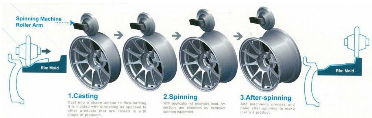
Figura 7.12: Descrizione del processo di flow-forming ( https://www.ambitwheels.com )
