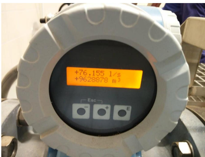
Figura 5.5 – Dettaglio del misuratore utilizzato per il monitoraggio in continuo della portata presso la sorgente Gruberwiesen.
