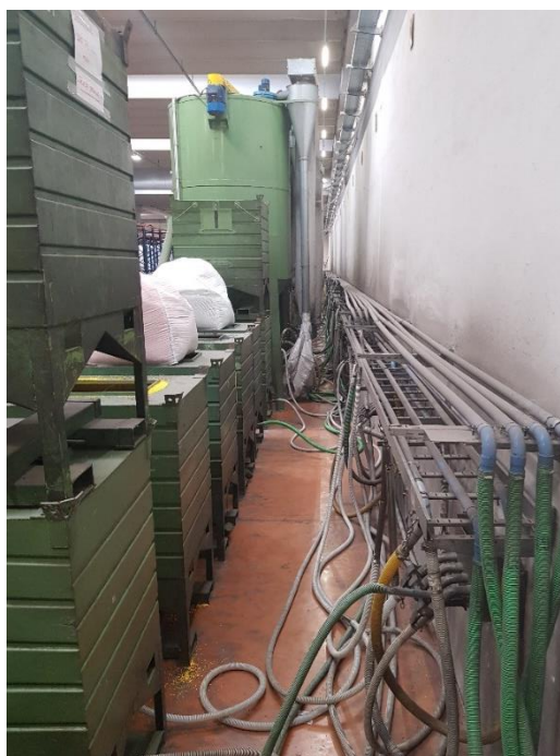
Figura 3. 5 Le lance aspirano il granulo dai sili e lo trasportano alle linee di estrusione
