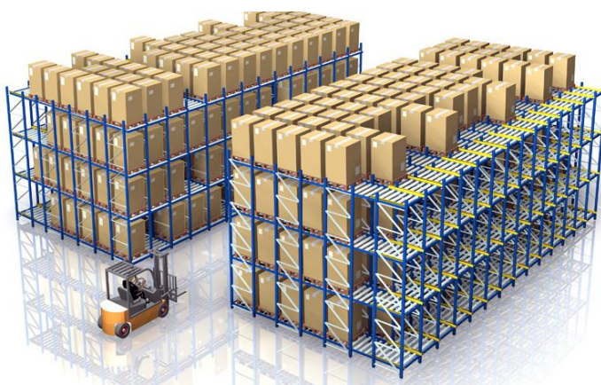
Figura 2. 4 Magazzino a gravità
