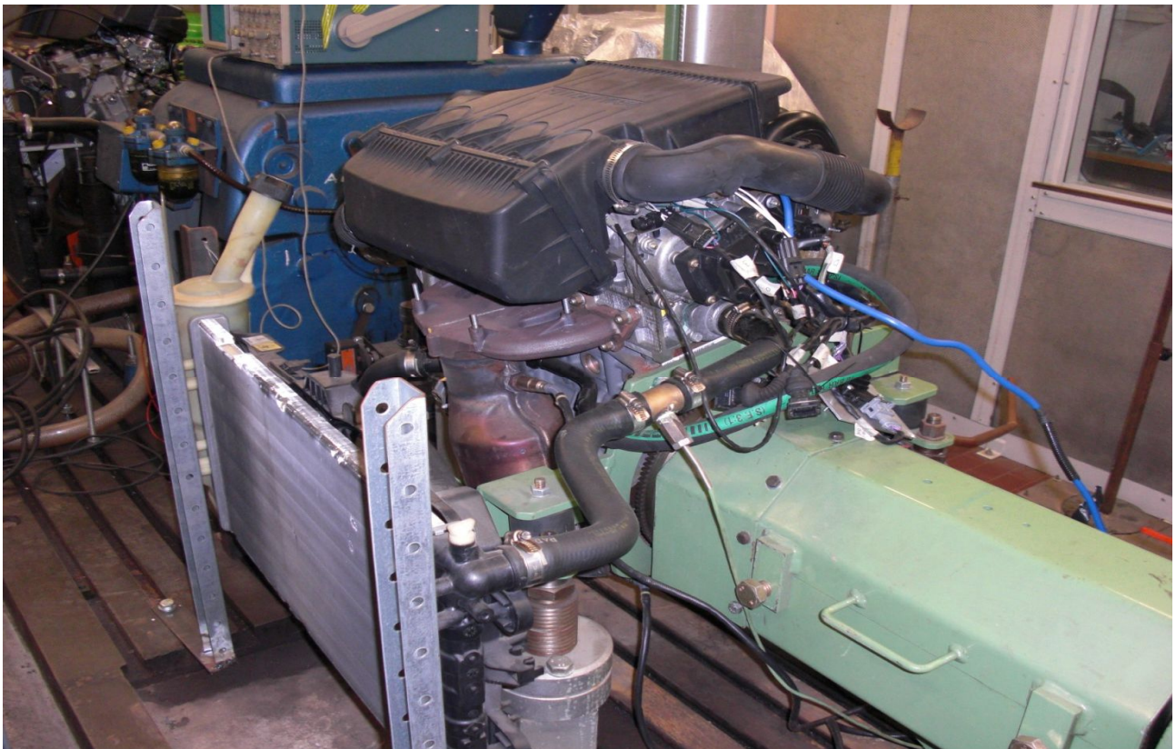
Fig. 2.4 Due viste del motore FIAT FIRE 1242 cc installato sul banco.
