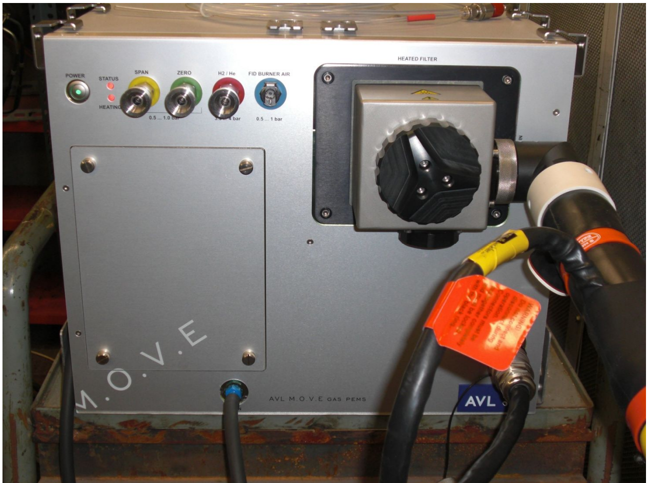
Fig. 2.11 Unità contenente i sensori dell'analizzatore AVL gas PEMS.
