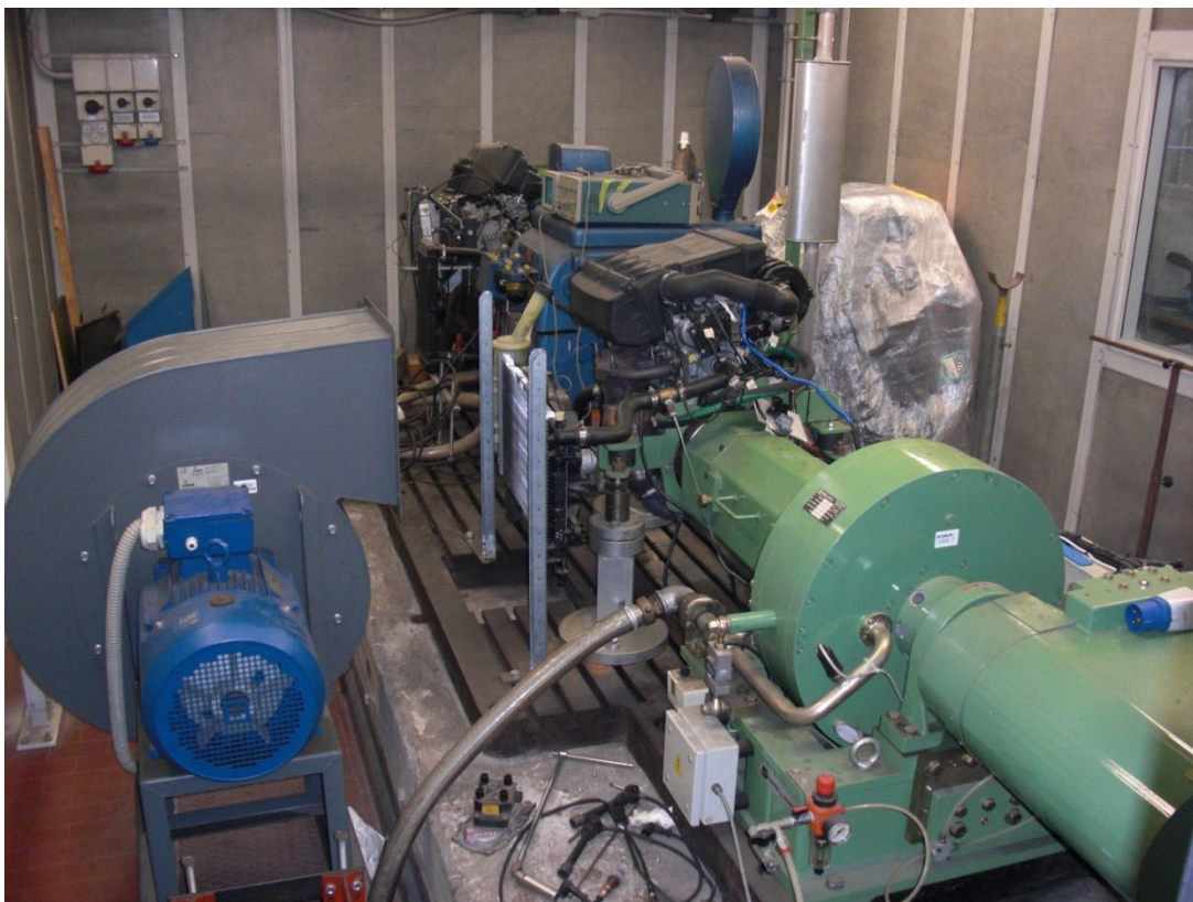
Fig. 2.5 Due viste del ventilatore centrifugo che permette al motore il mantenimento della temperatura di esercizio ottimale.
