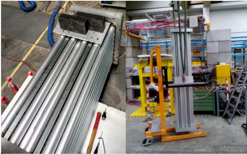
Figura 2.4: Sistema di barre laterali per posizionare la camera verticalmente
