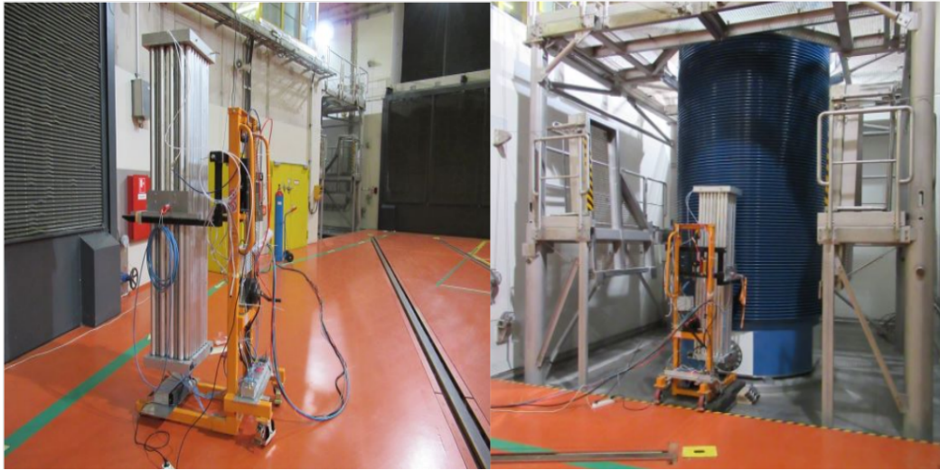
Figura 3.16: Immagini della presa dati nelle due posizioni: lontano dal (sinistra) e vicino al (destra) CASTOR ®
