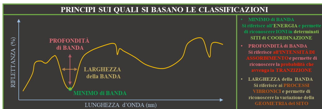
Fig. 5.11 Nello schema vengono riportati i 3 componenti su cui si basano le classificazioni.
