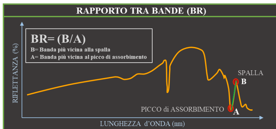
Fig. 5.1 In figura viene illustrato il funzionamento del rapporto tra bande.
