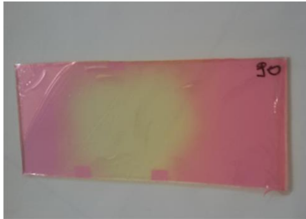
Figura 18 a: Piastra di fotopolimero dove si ha registrato l'ologramma corrisponde all'oggetto della stereopsi, si può distinguere la zona olografata, trasparente, dalla non olografata, rosa.
