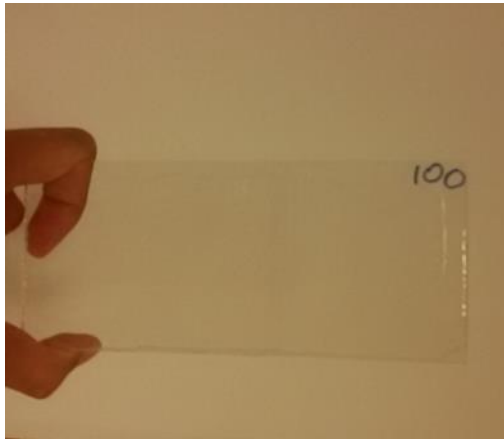
Figura 18 b: Piastra di fotopolimero registrata e esposta al sole, non si distingue la zona olografata. Questo da stabilità al materiale e permette migliore conservazione dell'immagine.
