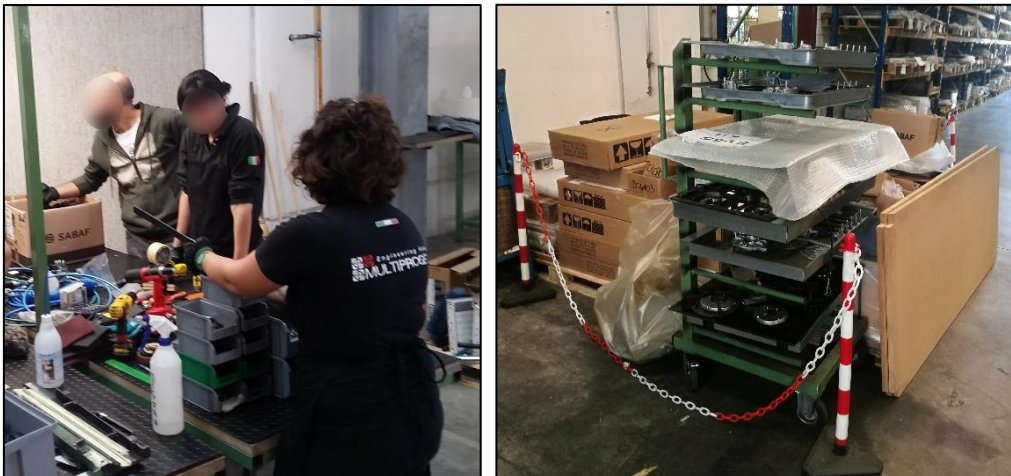
Figura 4.2.2. – Scelta del materiale da allontanare e definizione della red-area nella zona premontaggi in Multiproget Srl
