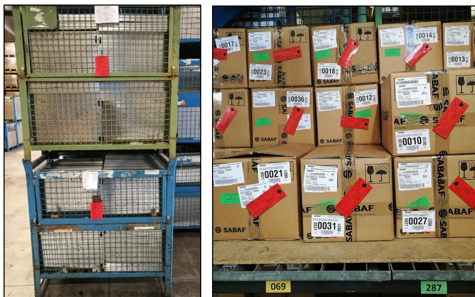
Figura 4.2.19. – Esempi di cartellini kanban utilizzati per le materie prime fondi e rubinetti
