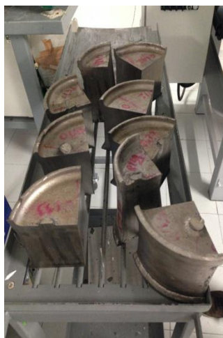
Figura 4.1 Blocchi pronti per i trattamenti termici
