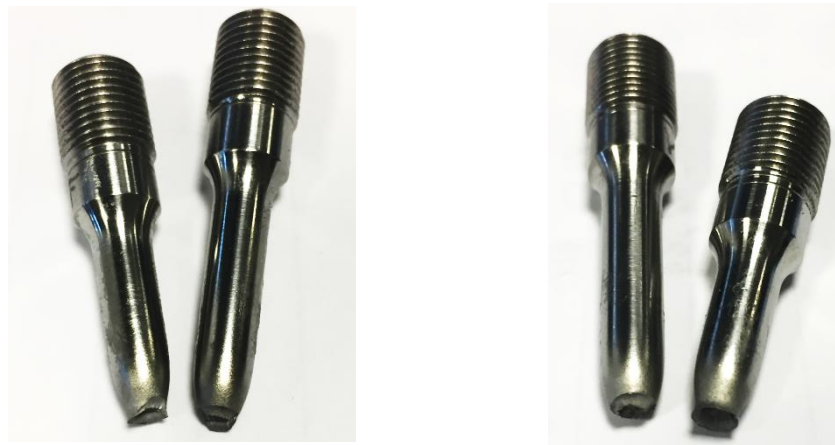
Figure 4.5 a, b Fotografie dei provini rotti mediante prova di trazione uniassiale: a) provino sottoposto a trattamento termico 1, b) provino sottoposto a trattamento termico 2
