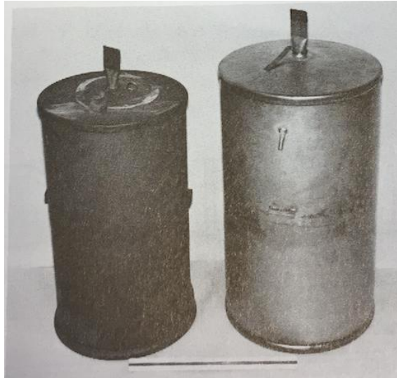
Figura 2.22 Billetta cilindrica sottoposta ad HIPping dopo e prima del processo. Sulla superficie superiore si osserva il tubo di riempimento, evacuazione e sigillatura.
