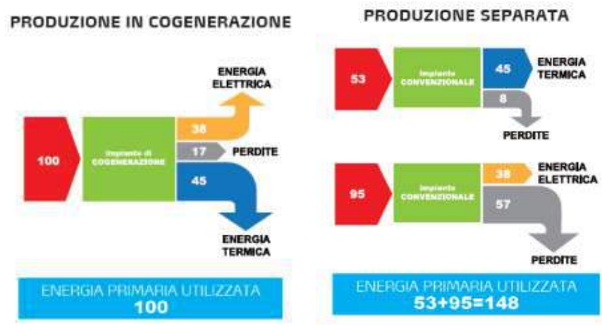
Figura 3.1. 1 Confronto produzione separata (sx) e in cogenerazione (dx)
