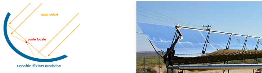
Figura 2.2. 8 Principio di funzionamento dei concentratori solari (sx) ed esempio di applicazione (dx)
