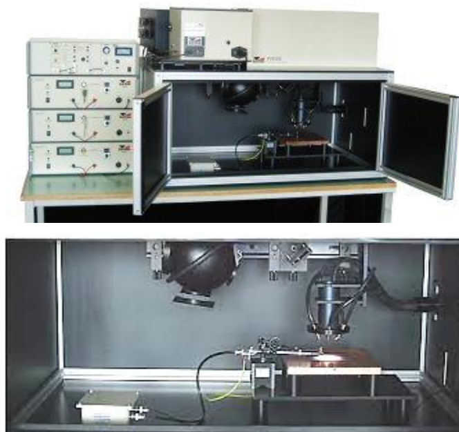
Figura 4.11: Il sistema di caratterizzazione fotovoltaica Bentham® PVE300, presente nel laboratorio MOSLAB.
