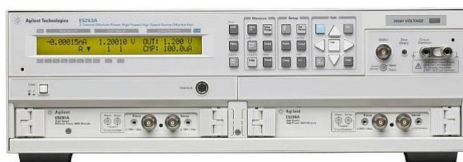
Figura 4.10: Sistema di parametrizzazione Agilent® E5263A (pannello frontale)
