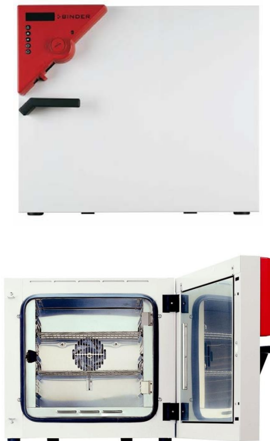
Figura 4.13: Forno a convezione termica BINDER® BF115, utilizzato per gli stress termici accelerati sulle celle a base di perovskite.
