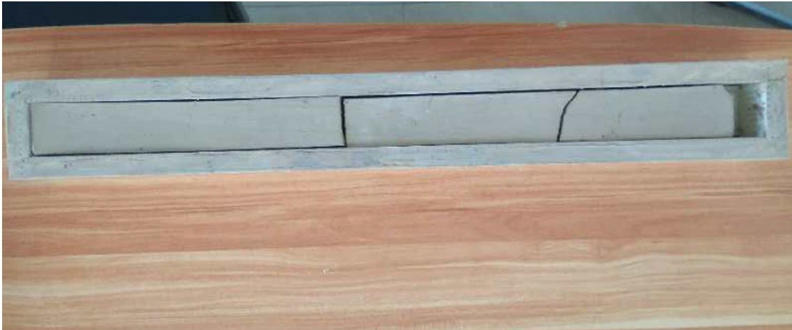
Figura 4.10. Risultato del test di Alcock. Stimato un ritiro del 5%.
