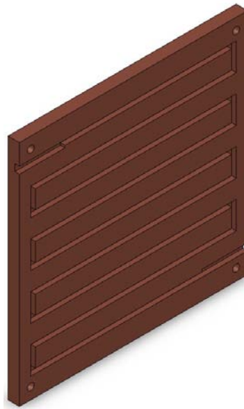
Figura 2.10: Piastra del riscaldatore su cui è inciso il percorso a serpentina
