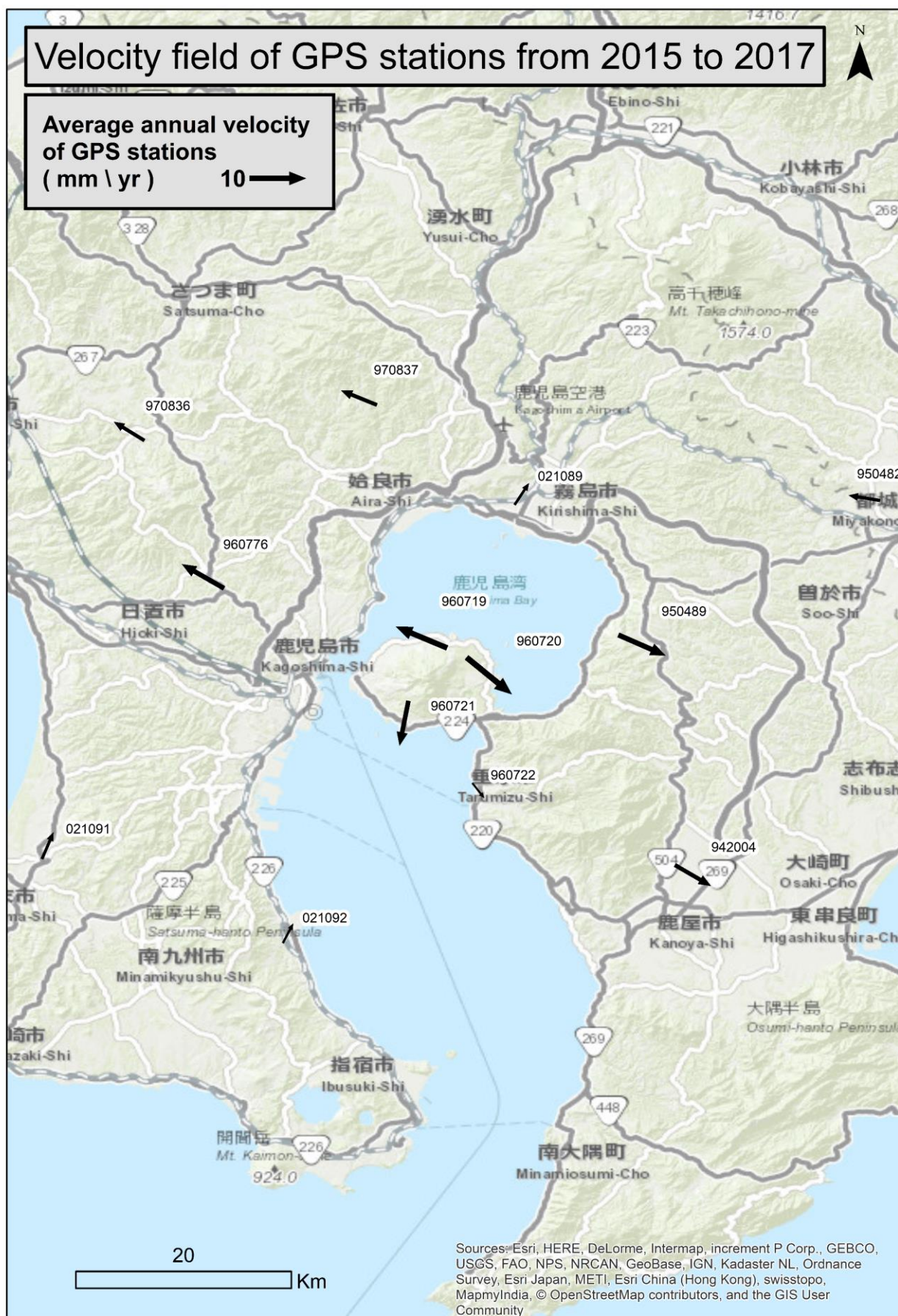
Allegato 4. I vettori, plottati in ArcMap (v. 10.4.1), indicano le velocità medie annuali per ogni stazione GPS presente sul vulcano Sakurajima e nell'area limitrofa, private della componente regionale della velocità dovuta al movimento delle placche.
