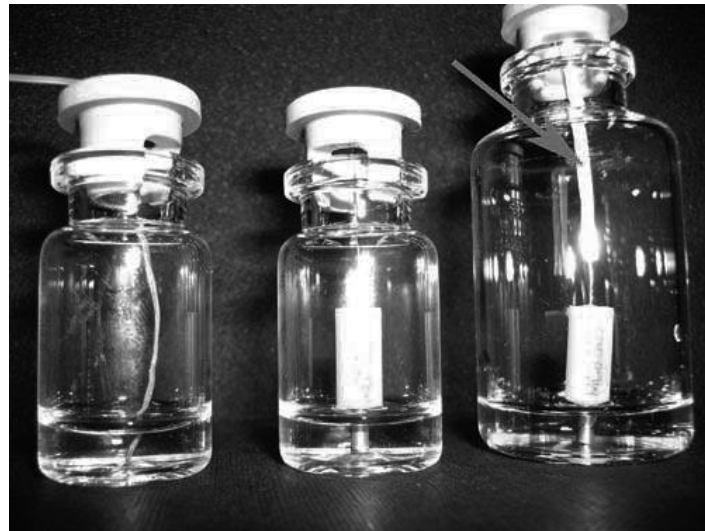
Figura 1.10. Confronto tra termocoppia a filo e termocoppie wireless , in flaconi di diverse dimensioni (5 mL per i due flaconi a sinistra, 20 mL per il flacone a destra). La freccia indica un filo in teflon ancorato al tappo del flacone che permette un posizionamento accurato della termocoppia (Schneid e Gieseler, 2008)
