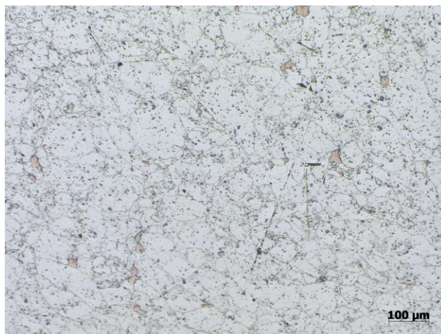
Figura 3.47 Al-2Cu Muffola 30 min. (100X) OTTICO
