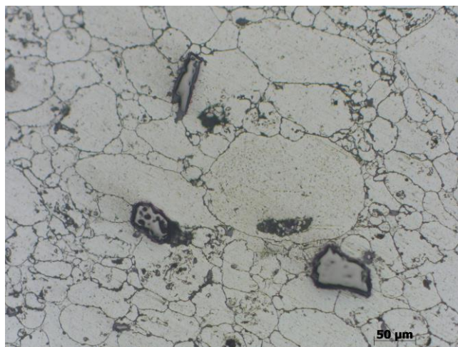
Figura 3.53 Al-4TiC Muffola 60 min. (200X) OTTICO
