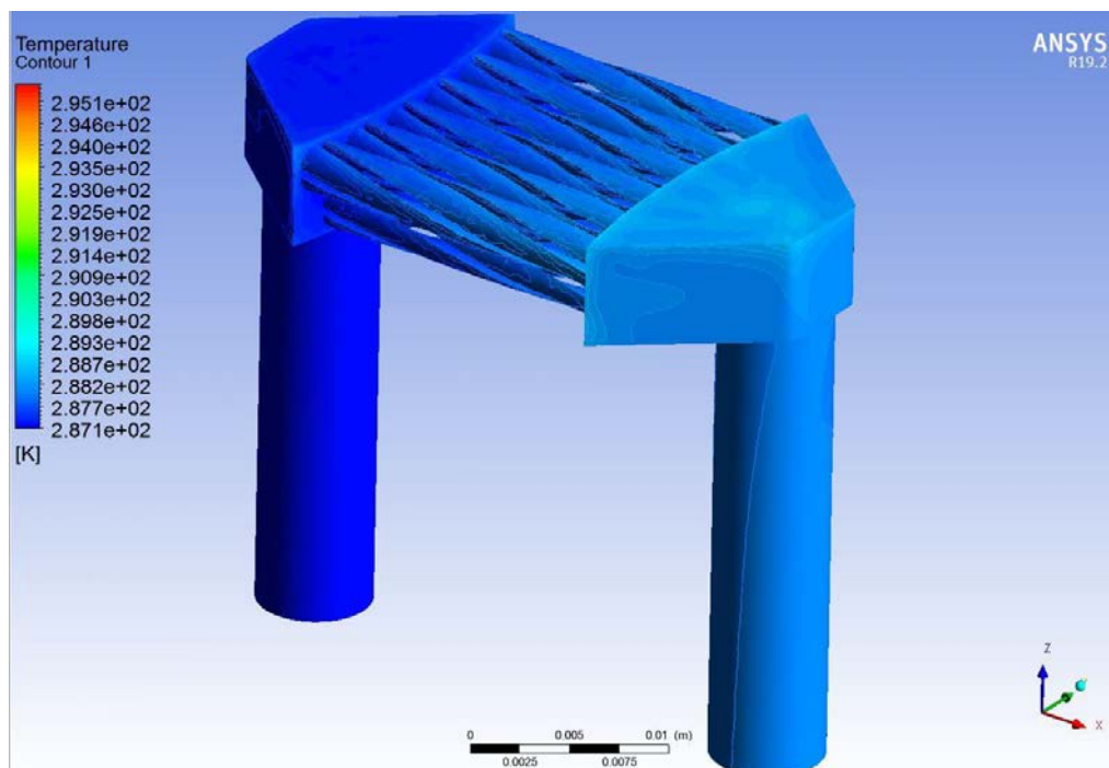
Figura 4.35: Vista assionometrica della mappatura delle temperature del fluido refrigerante che scorre all'interno dei micro-canali elicoidali.
