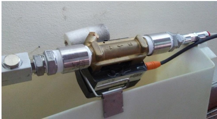
Figura 3.14: Flussimetro Burkert Type 8081 utilizzato per la misura della portata del fluido refrigerante.
