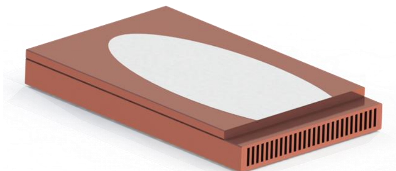
Figura 1.16: Sistema costituito dal target nella parte superiore e da un dissipatore di calore a lamelle nella parte inferiore.
