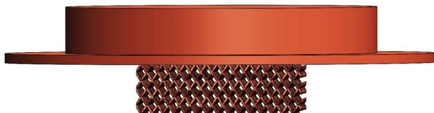
Figura 4.3: Modellazione geometrica del dissipatore di calore a griglia metallica a micro-canali dritti.
