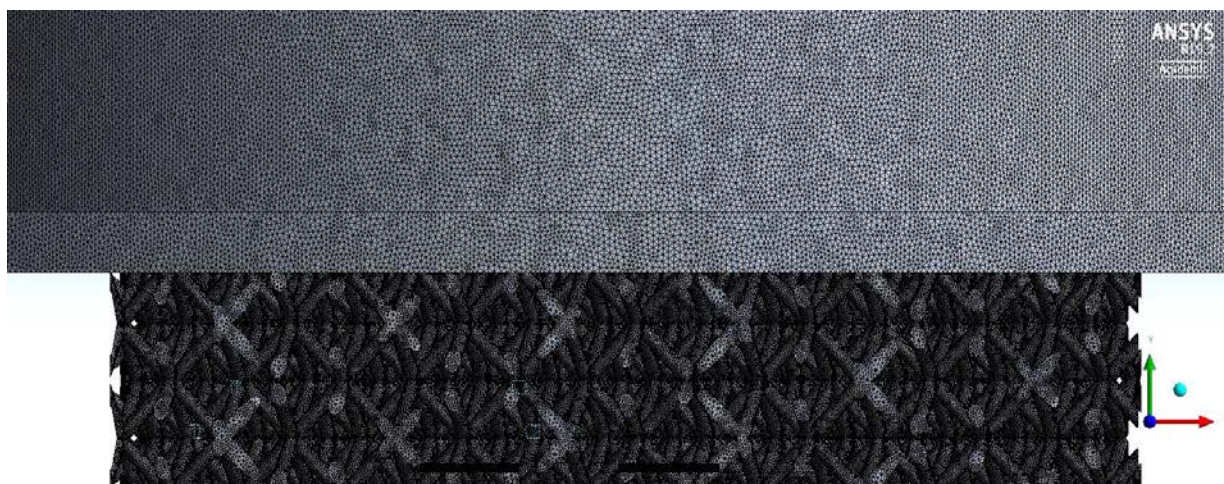
Figura 4.26: Rappresentazione grafica della mesh del dissipatore di calore a griglia metallica a micro-canali inclinati di 25^\circ .
