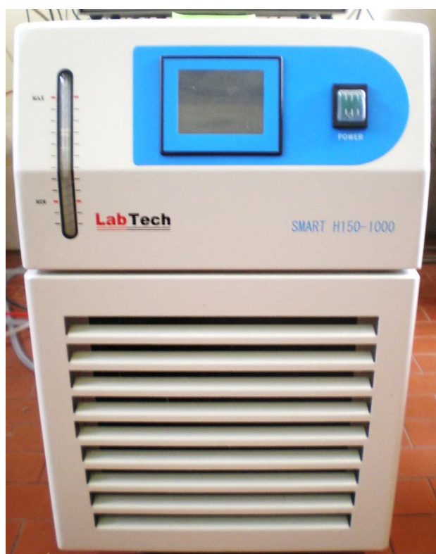
Figura 3.8: Chiller di raffreddamento Labtech H50/H150.
