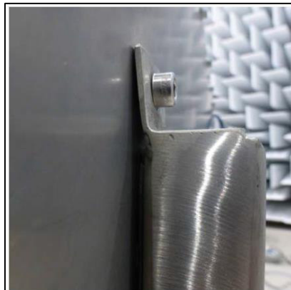
Figura 4.16 – Fotografia della chiusura del box fonoisolante studiato come “Caso studio 2” per la validazione del Software SEA con particolare della guarnizione in compressione.
