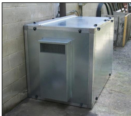
Figure 1.2 - Esempio di copertura integrale di una macchina industriale
