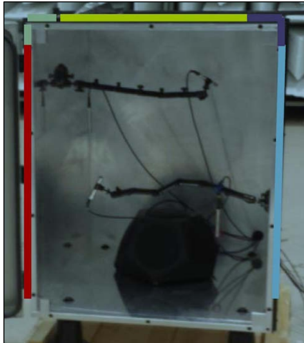
Figura 4.32 - Fotografia del box studiato come “Caso studio 3” per la validazione del Software SEA, sono presenti i 6 microfoni di acquisizione sonora e la sorgente sonora semidodecaedrica. Sono indicate con colori diversi le zone relative alle scansioni lineari effettuate sulle guarnizioni di chiusura. Si sono svolti 5 rilievi indipendenti per valutare l'effetto della potenza irradiata dalle guarnizioni nelle diverse condizioni di compressione delle stesse. In rosso la guarnizione sinistra, in verde chiaro guarnizione d'angolo superiore sinistra, in giallo guarnizione superiore, in viola guarnizione d'angolo superiore destro ed in azzurro guarnizione destra.
