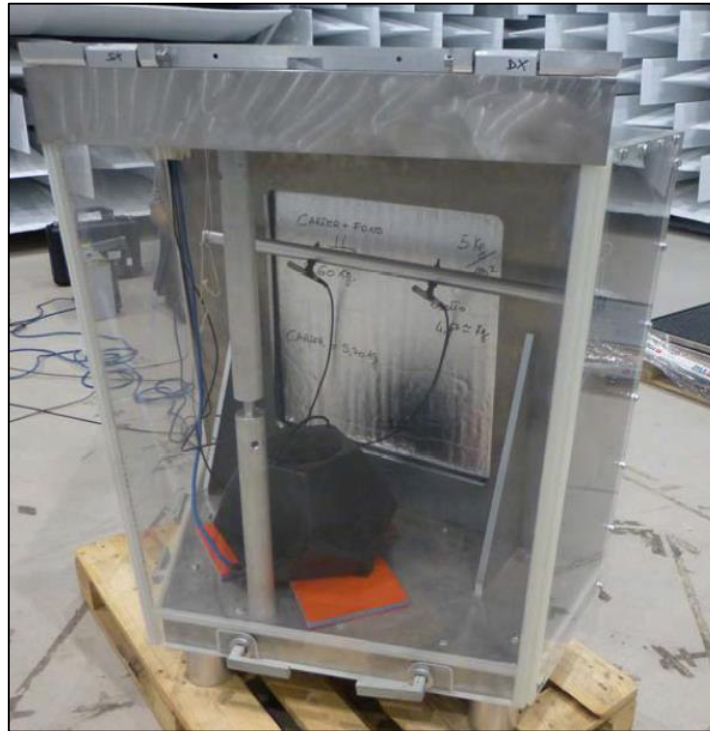
Figura 4.9 - Fotografia del box studiato come “Caso studio 2” per la validazione del Software SEA, nella fotografia sono presenti i microfoni di acquisizione sonora e la sorgente sonora semidodecaedrica .
