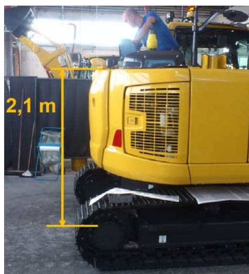
Figura 4.17: Situazione di rischio a causa della salita sulla macchina
