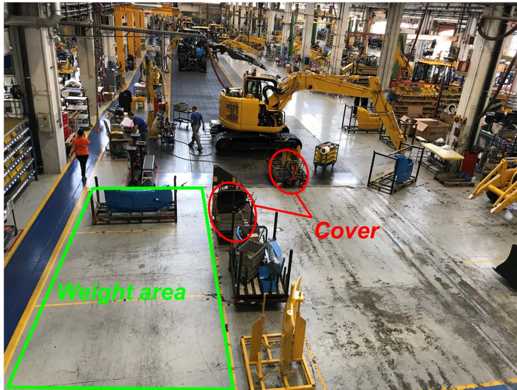
Figura 4.18: Foto dall'alto della zona in cui vengono montate le cover e la zavorra
