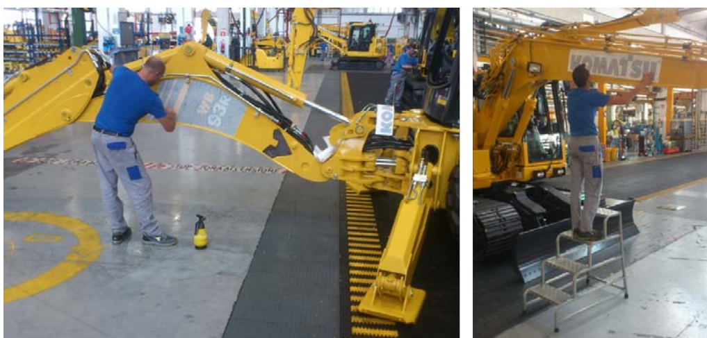
Figura 4.24: Prove di decalcatura dei bracci eseguite in linea
