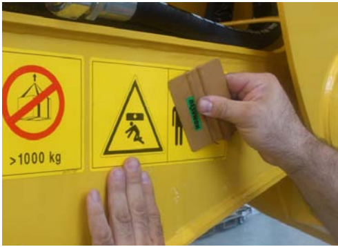
Figura 3.9: Fissaggio dell'adesivo con la spatola
