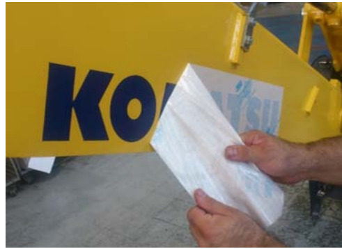
Figura 3.10: Rimozione della carta adesiva usata per applicare le scritte
