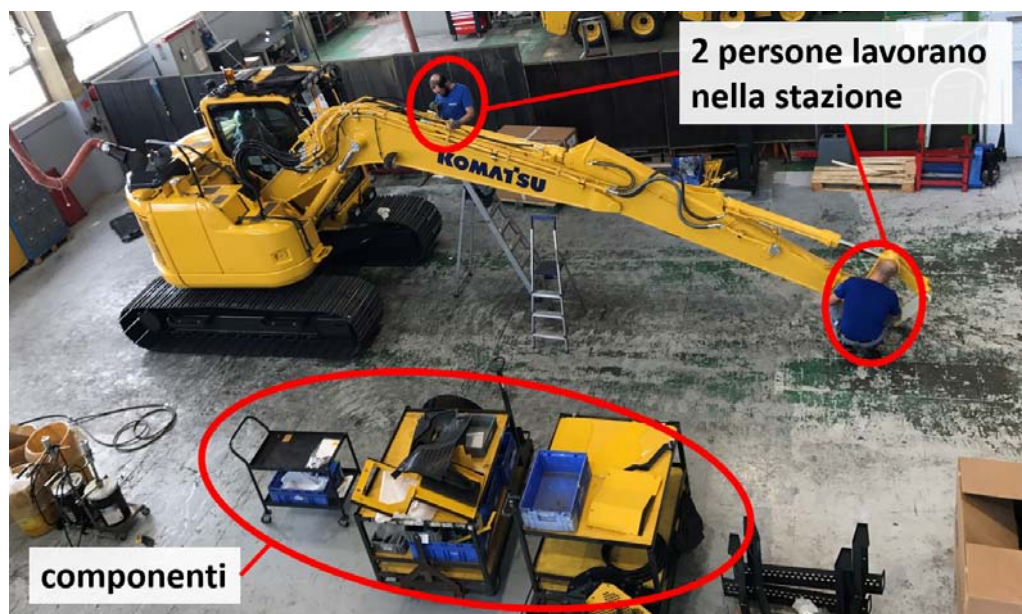
Figura 3.3: Foto di una stazione di allestimento
