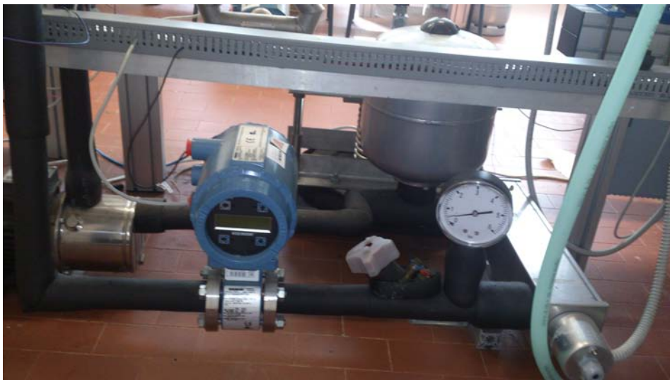
Figura 2.6: Il circuito della sezione evaporante: si notano in basso a destra il riscaldatore elettrico e il vaso di espansione in secondo piano
