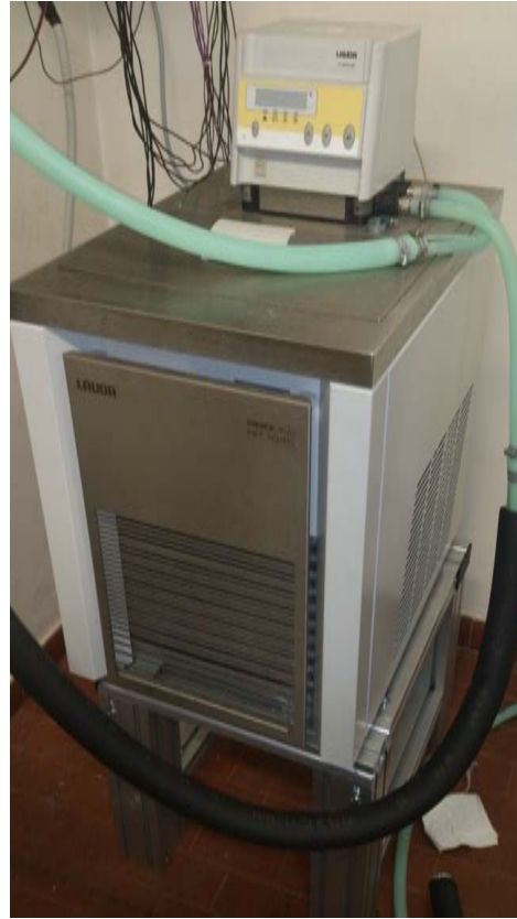
Figura 2.8: Il bagno termostatico che fornisce acqua alla sezione sperimentale
