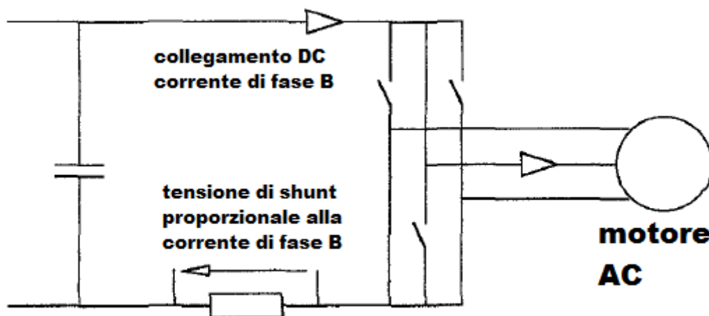
fig.5.2 schema inform, misura di corrente sul solo collegamento DC
