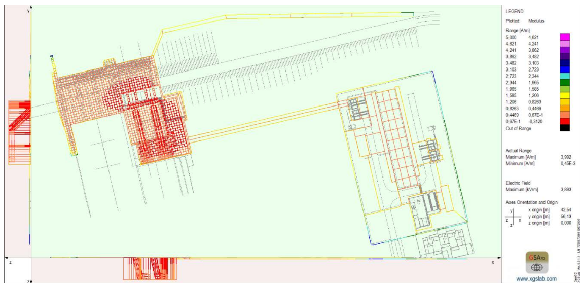
Figura 20: Distribuzione della corrente dispersa dalla rete di terra
