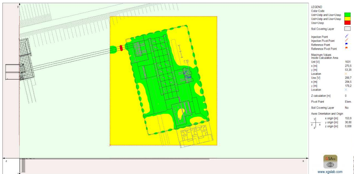
Figura 34: Aree sicure con i cavi di collegamento tranciati
