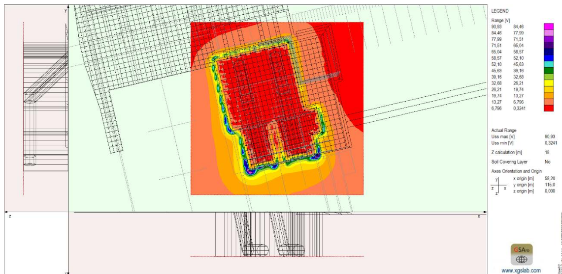
Figura 29: Distribuzione della tensione di passo
