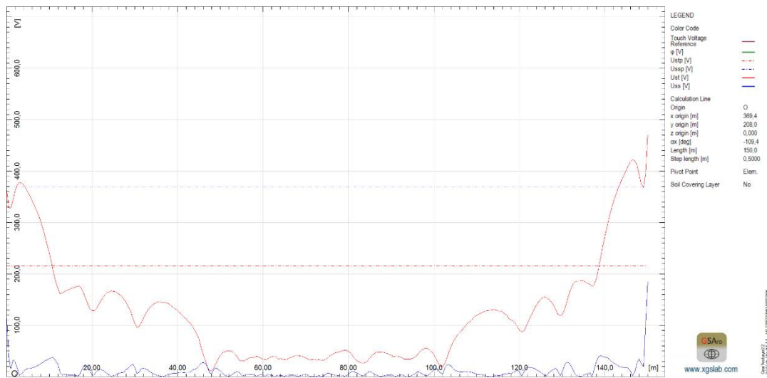
Figura 69: Tensione di contatto e di passo lungo la diagonale layout 2 - Alto senza aste - Basso con aste
