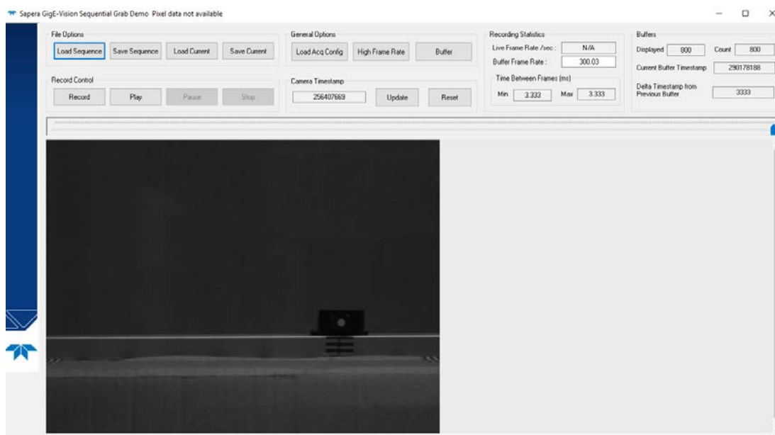
Figura 3.10: Schermata del software “Spera CamExpert” utilizzato per l’acquisizione video. In alto a destra è possibile visualizzare i parametri impostati per l’acquisizione: 300,03 fps di frame rate e 800 fps di buffer.
