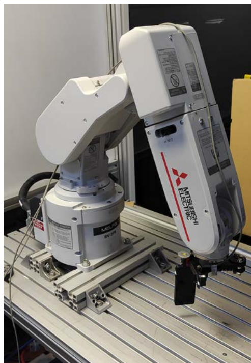
Figura 5.6: Robot antropomorfo modello "RV-2FRL-D" prodotto dalla "MITSUBISHI ELECTRIC", utilizzato per effettuare le prove con il secondo prototipo di end-effector, montato sul robot.
