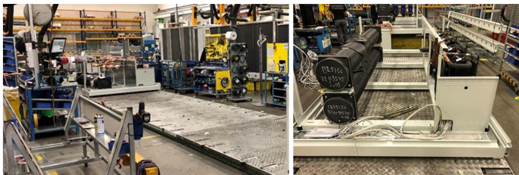
Figura 5.22 L'effetto del problema al passaggio di unità "pesanti" N e Q sulla linea: il "vuoto" nelle postazioni a valle della fase IMF e la "coda" in quelle a monte (fonte interna MEHITS)
