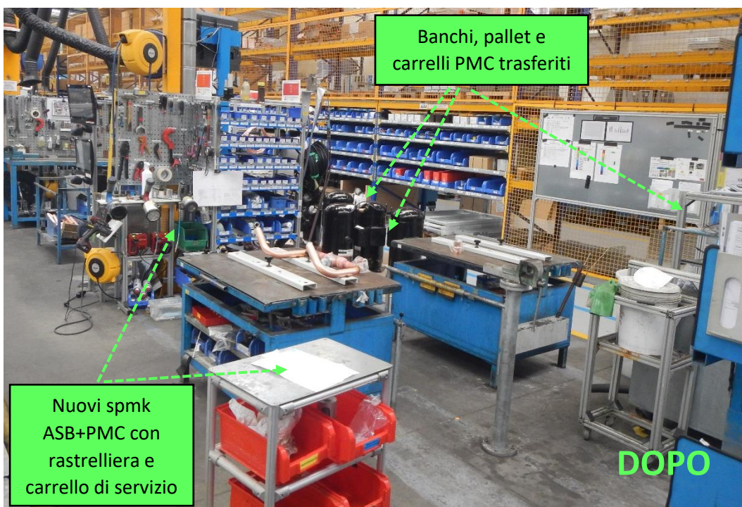
Figura 7.11 L'area ASB prima e dopo il del layout, integrando in P1 la fase PMC (immagine adattata da fonte interna MEHITS)
