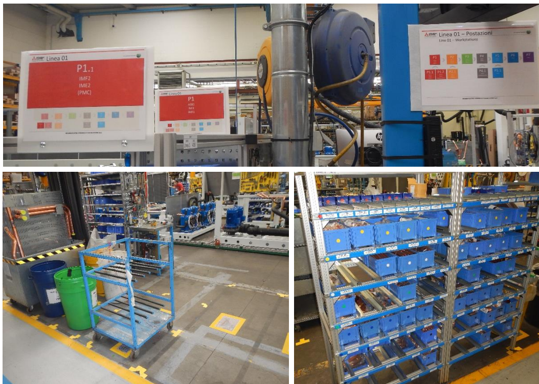
Figura A.7.11 Esempi di nuovi standard: definizione nuove postazioni in linea 1 con al loro interno le "sottofasi" di assemblaggio, ingombri a terra e bollini colorati per fila sulle scatole per un più rapido ripristino del supermarket (fonte interna MEHITS)
