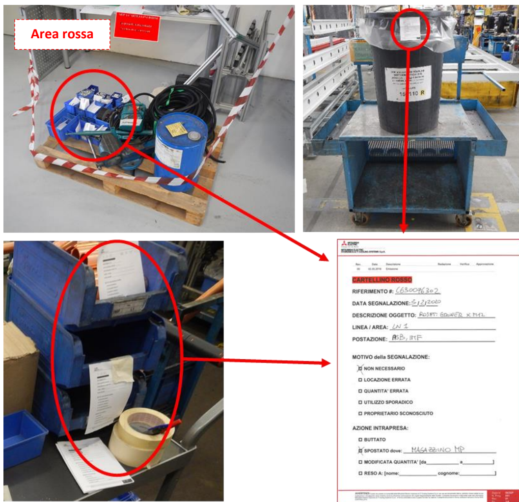
Figura A.7.5 L'applicazione del Red tag e la Red area durante la 1^S (immagine adattata da fonte interna MEHITS)
