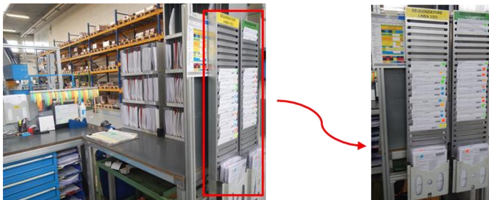
Figura 5.8 I sequenziatori delle linee (“heijunka box”, immagine adattata da: fonte interna MEHITS)
