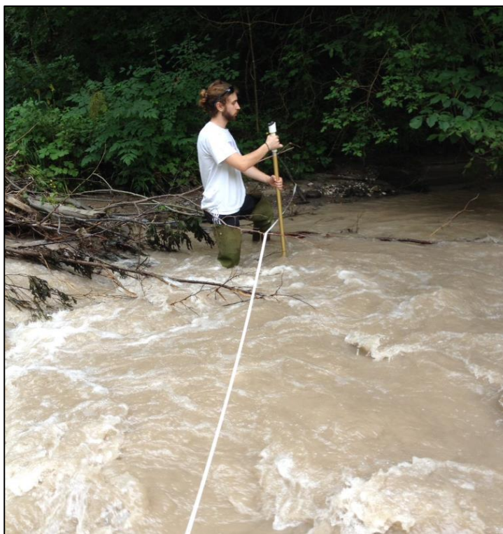
Figura 4.14 – Esempio della misurazione con mulinello idrometrico del Rio Funes.
