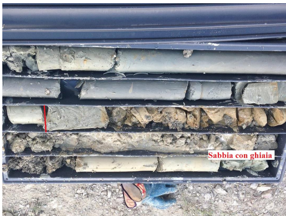
Fig. 7 - In questa foto è presente il contenitore del materiale prelevato tra i 15 e i 20 m.d.p.c. [Regenesis].
