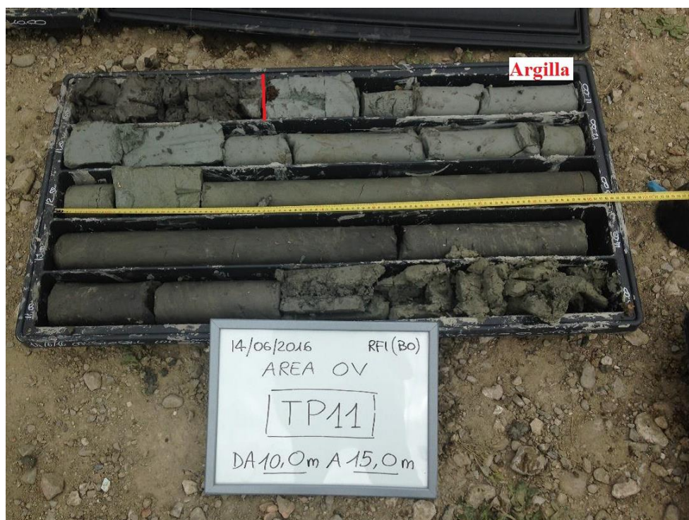
Fig. 6 - In questa foto è presente il contenitore del materiale prelevato tra i 10 e i 15 m.d.p.c. [Regenesis].
