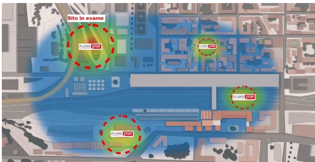
Fig. 23 - Localizzazione dei trattamenti eseguiti all'interno del plume dalla Regenesis, l'intervento di nostro interesse è solamente quello localizzato in alto a sinistra. [Regenes].
