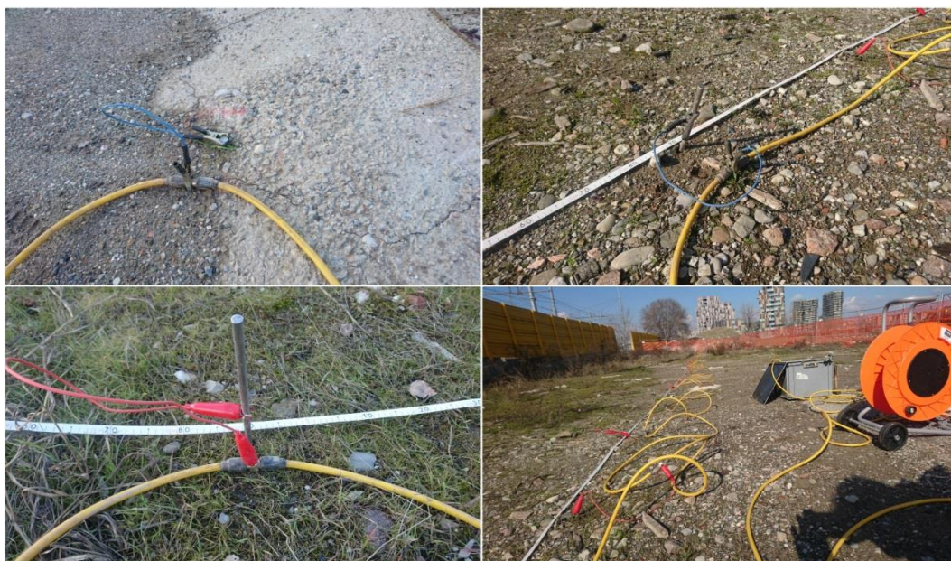
Fig. 25 - Diverse tipologie di terreno dove sono stati infissi gli elettrodi, rispettivamente cemento, terreno di riporto e terreno con copertura vegetale.
