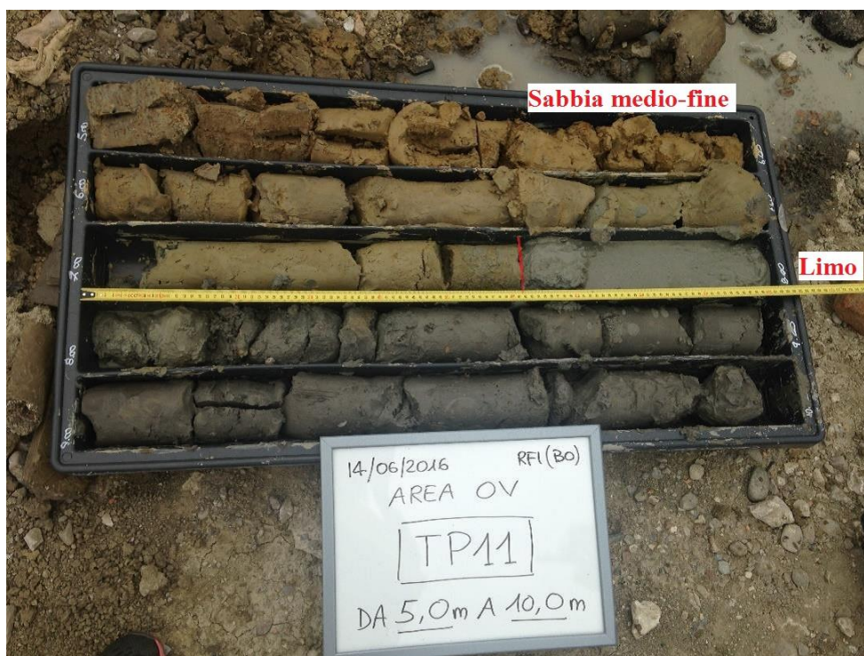
Fig. 5 - In questa foto è presente il contenitore del materiale prelevato tra i 5 e i 10 m.d.p.c. [Regenesis].
