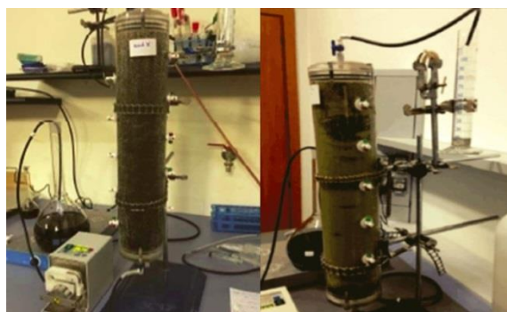
Fig. 19 - Prove test in laboratorio con test in colonna.
