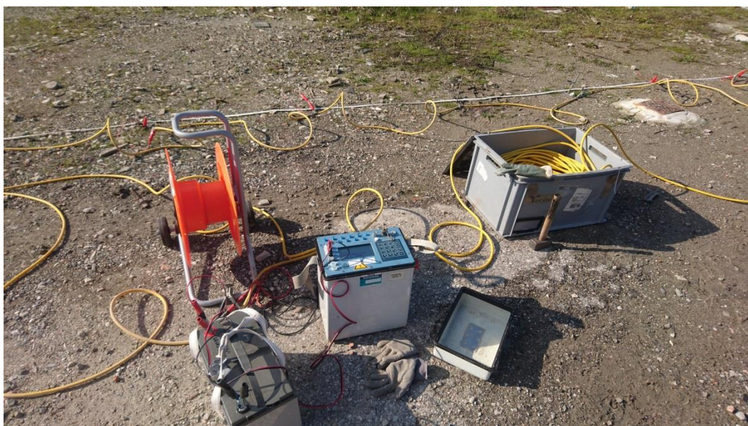
Fig. 12 - Georesistivometro utilizzato per eseguire la tomografia elettrica, si tratta di un Syscal Pro della IRIS Instruments di proprietà del dipartimento di Geoscienze di Padova.
