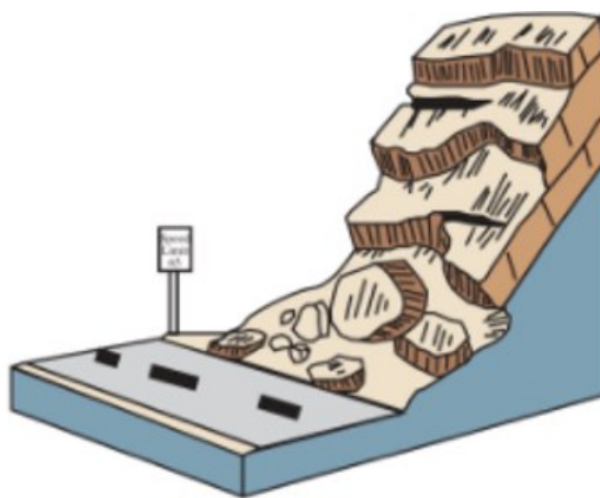
Figura 2 - Esempio frana di crollo
