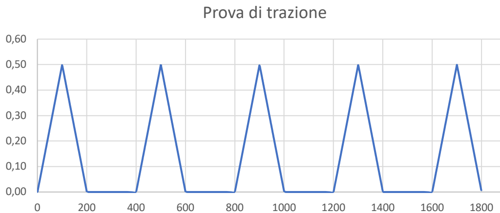
Figura 4.8: Prove di trazione con cinque cicli di carico/scarico.
