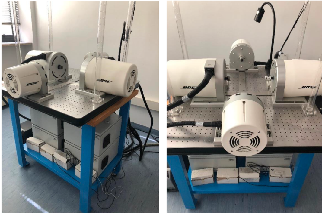
Figura 4.6: Strumentazione Bose® per le prove meccaniche [66].
