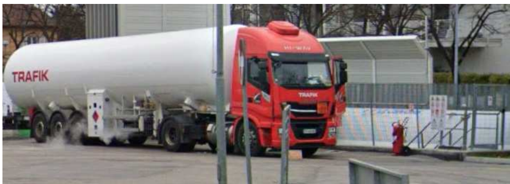
Figura 3.2 – Autocisterna per il trasporto di GNL
