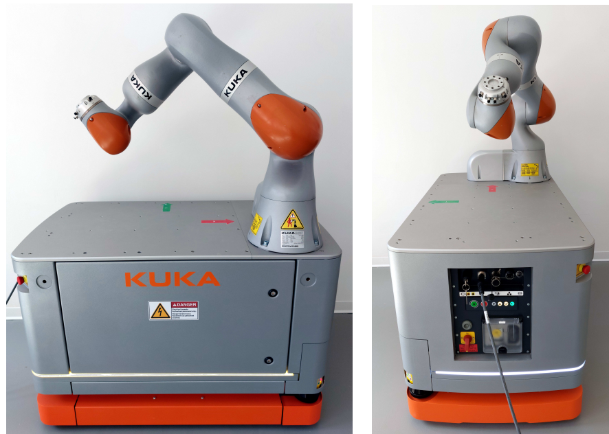
Figura 4.1: Posizione manipolatore per il movimento collaborativo.
